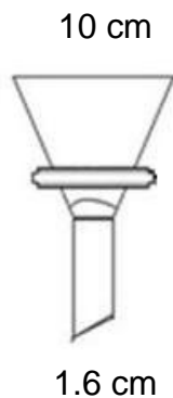
Figura N° 13. Dimensiones reales del embudo utilizado.
