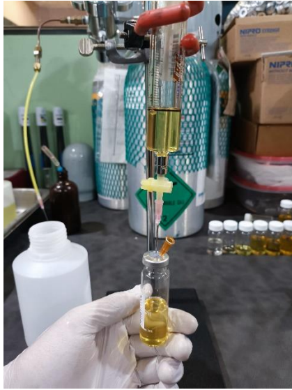
Ilustración 26. Equipo para medir la humedad relativa en el aceite.
