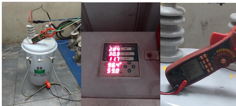
Ilustración 13. Configuración para prueba de cortocircuito y resultados
