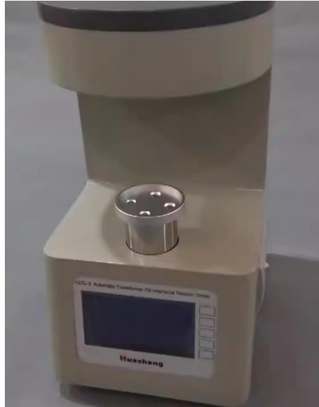
Ilustración 29. Equipo para realizar la prueba de tensión interfacial en el aceite dielectrico.
