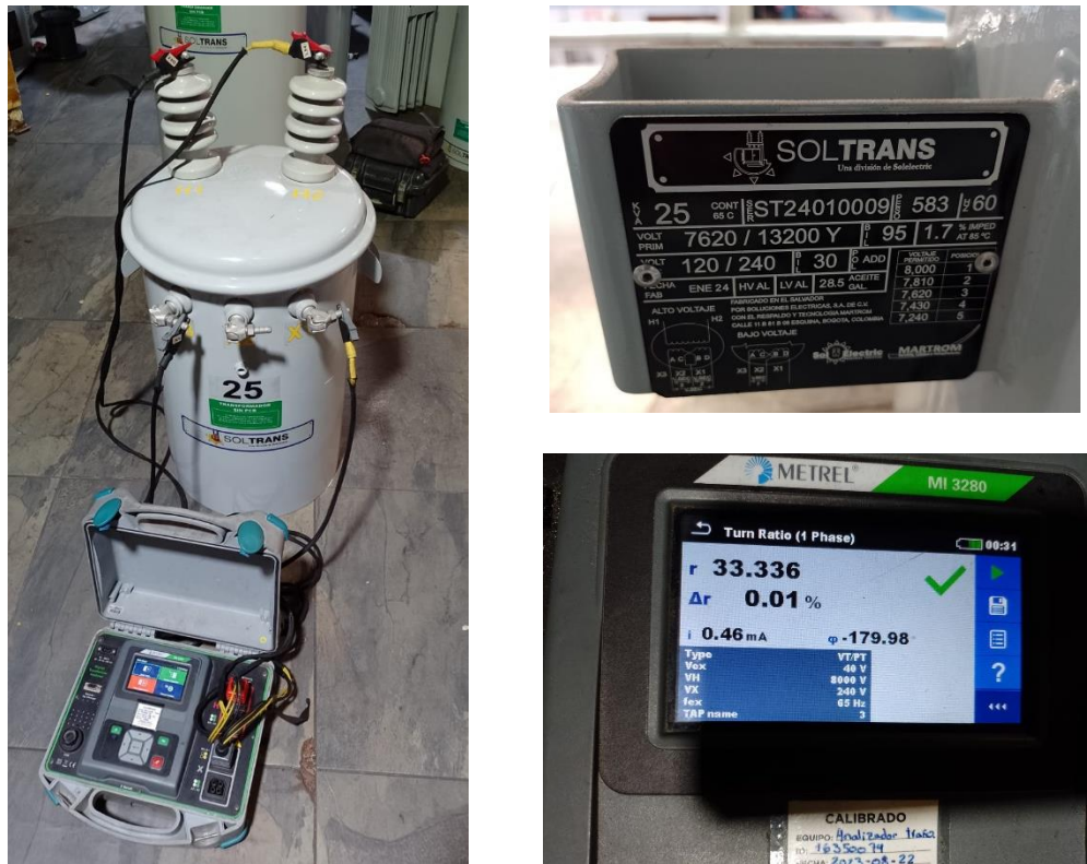
Ilustración 33.. Configuración de equipo para pruebas de Relación de Transformación
