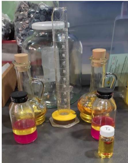
Ilustración 27. Prueba de Acidez en aceite dieléctrico
