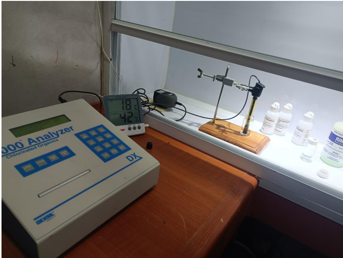
Ilustración 31. Equipo para realizar prueba de PCB en aceite dieléctrico.
