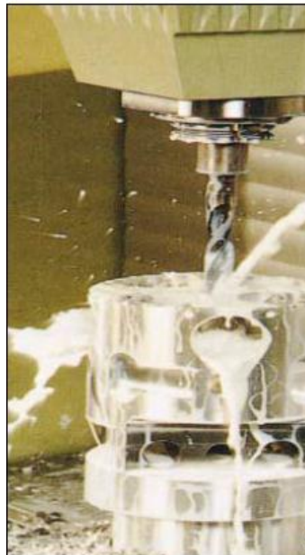
Fig.1.7. Uso de taladrina en procesos de maquinado.
