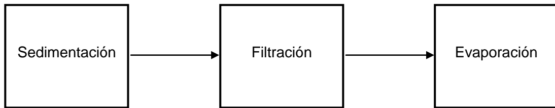
Fig. 3.7: Proceso de tratamiento del aceite para disminuir el volumen.
