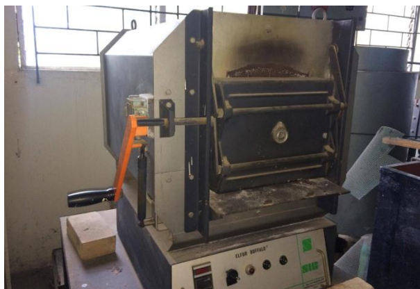
Fig. 2.11. Calentamiento de la pieza en hornos.
