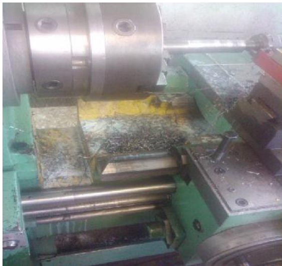
Fig. 1.8. Producción de viruta contaminada con fluido de corte en proceso de taladrado.
