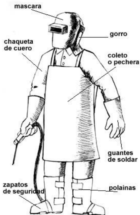
Fig. 1.9. Utilizando el equipo de seguridad personal adecuado.
