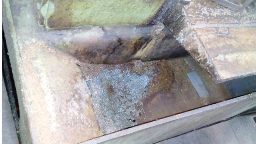
Fig.2.3. Depósito donde se recolecta la viruta generada por el proceso de corte y se conduce el fluido de corte (detalle de la Fig. 2.2).
