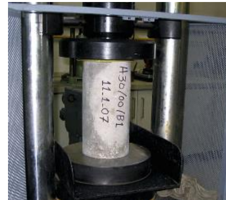
Imagen 26. Prueba de resistencia a la compresión.
