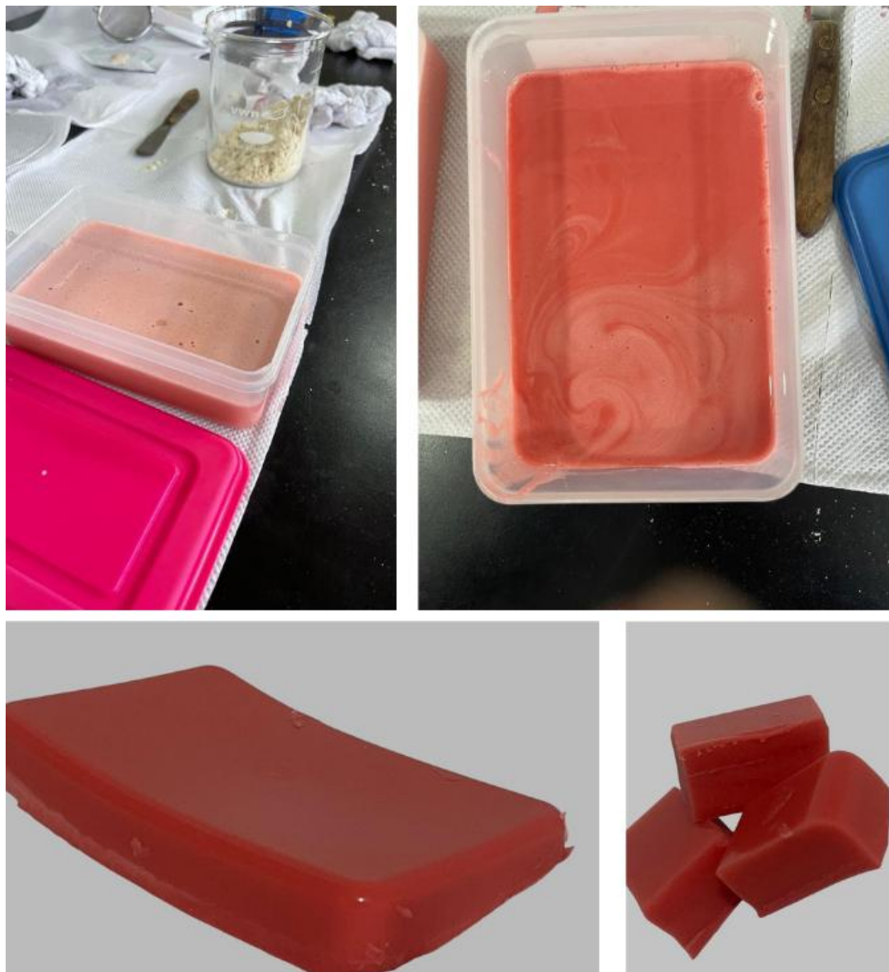
Figura D.7 – Prueba de laboratorio de gomitas en molde rectangular grande, desmoldeo y corte de gomitas.
