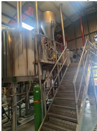
A- 2 Tanque de maceración, hervor y centrifugación
