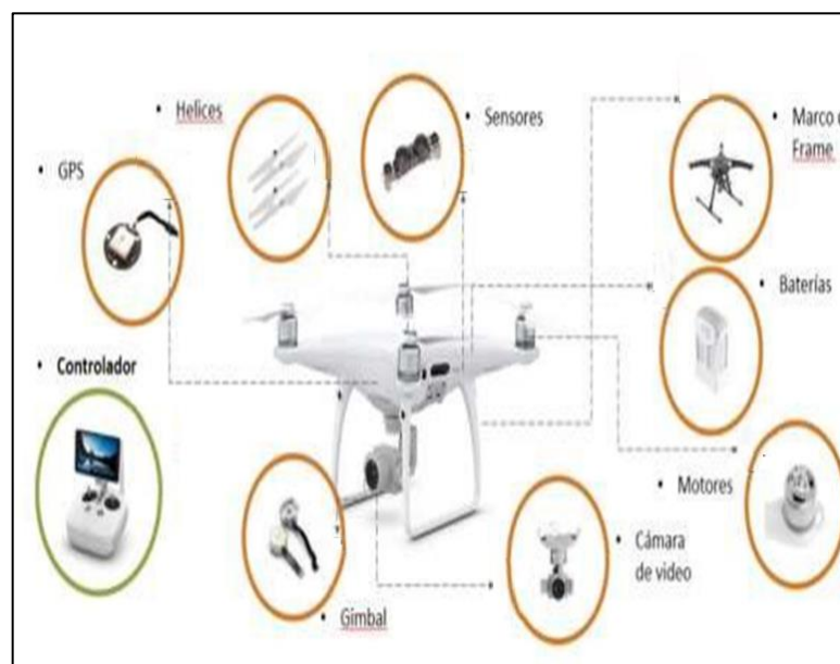
Figura N° 61. Partes de un Dron fotogramétrico
