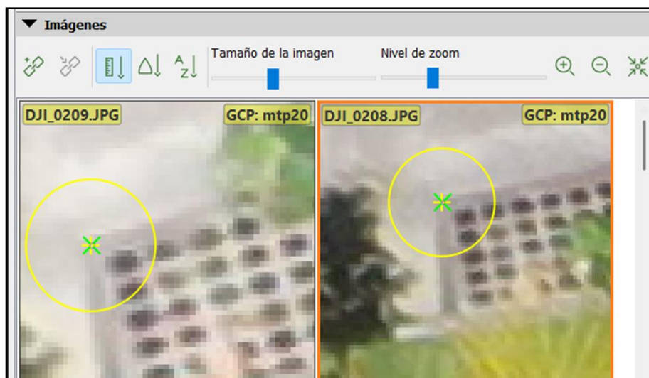
Figura N° 100. Verificando colocación de puntos de paso
