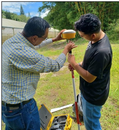
Figura N°. 79 Ensamblando el jalón con el colector
