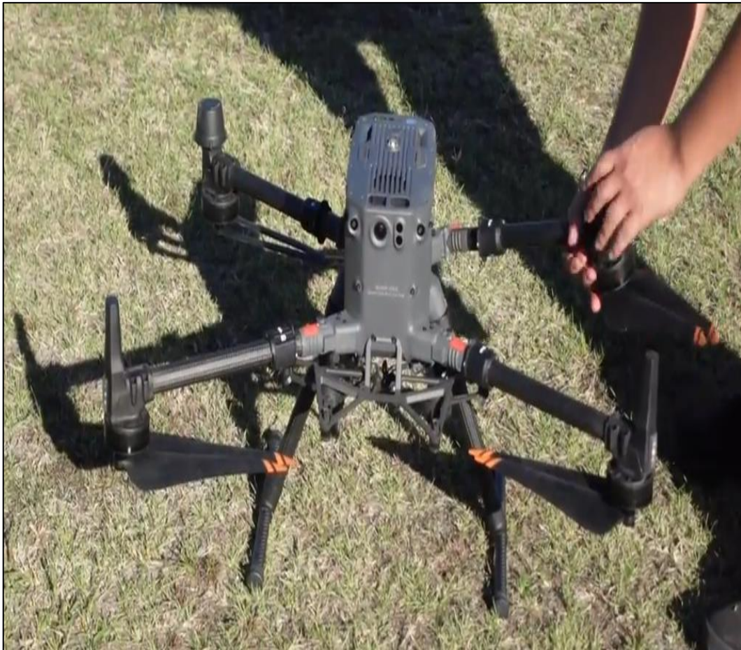
Figura 148. Dron: DJI matrice 350 RTK – Preparación de las hélices
