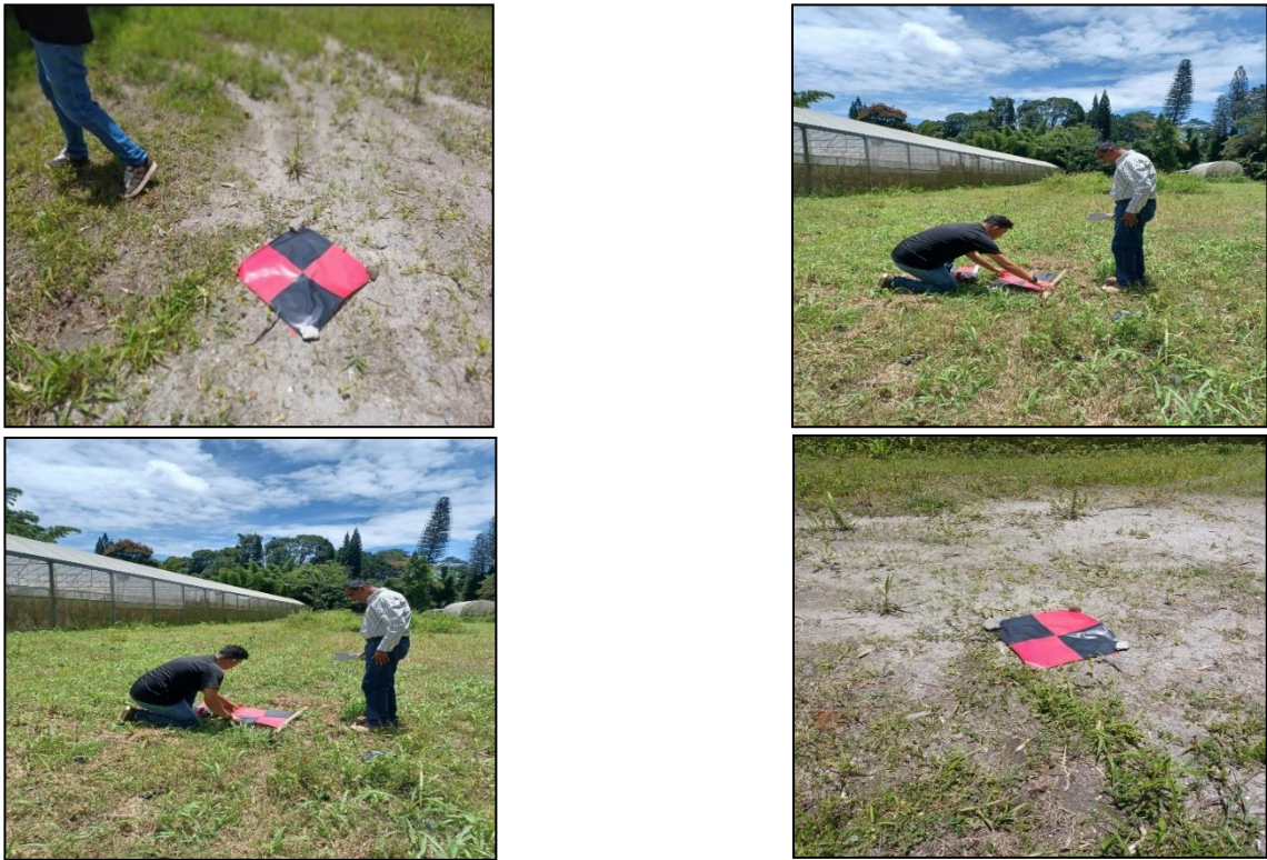
Figura N° 67. Colocación de estaciones para puntos de control.
