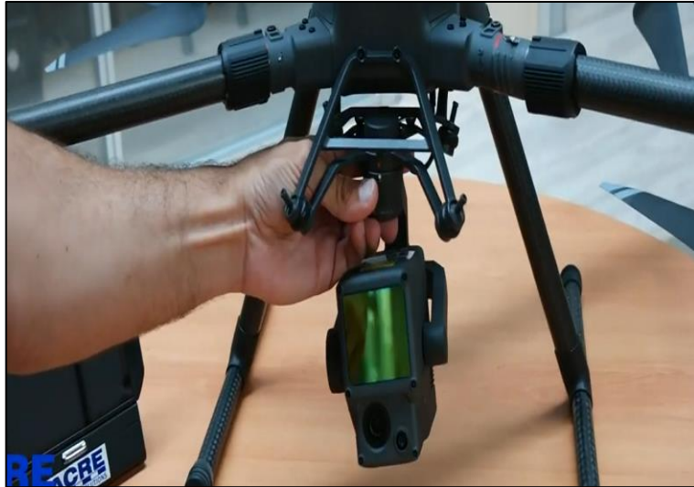
Figura 149. Sensor LIDAR Dji Zenmuse – Colocación
