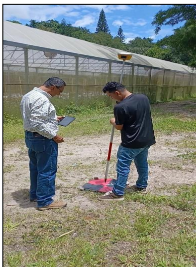
Figura N° 81. Toma de puntos de control PCF
