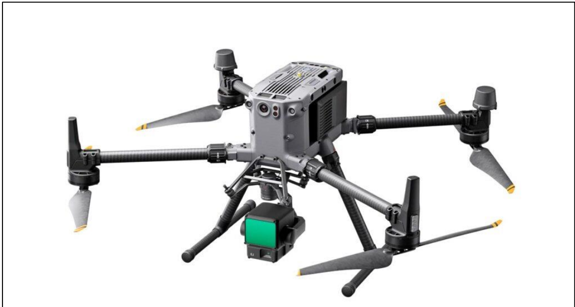
Figura N° 147. Dron: DJI matrice 350 RTK y sensor LIDAR Dji Zenmuse L2
