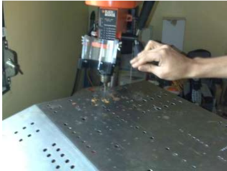
Fig. 2.29. Perforación de la lámina.
