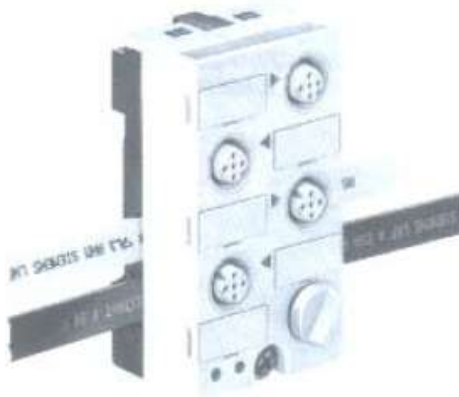
Fig. 5.29. Fijación de cable con esclavo.
