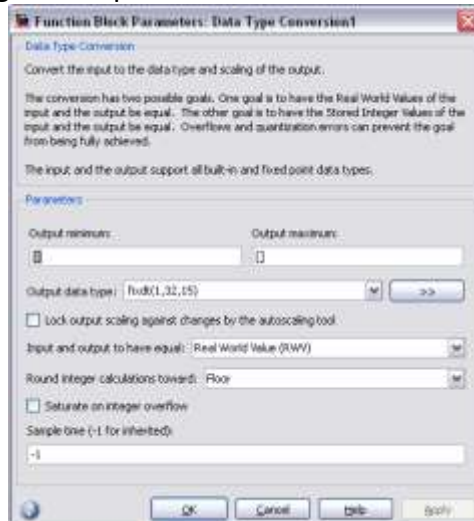
Fig. 3.31. Parámetros definidos a bloques “Data Type Conversion”.
