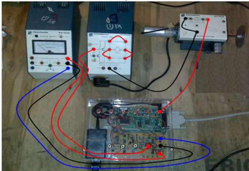
Fig. P1.5. Conexión del kid feedback al Modulo Digital eZdsp F2812.
