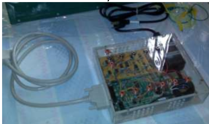
Fig. C.3. a) vista superior del modulo controlador b) vista del controlador con la conexión del cable paralelo y la extensión de alimentación.
