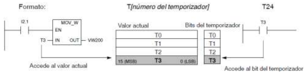
Fig. A.7. Acceder al bit del temporizador o al valor actual de un temporizador.
