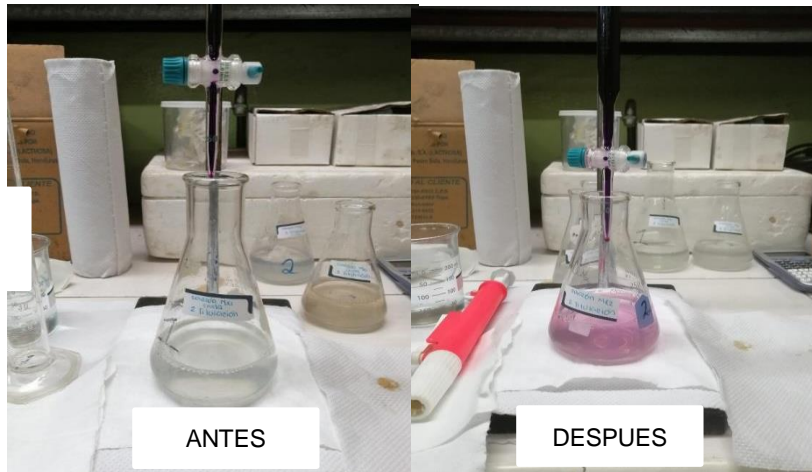
Figura N° 15. Valoración con permanganato de potasio. Fuente: Elaboración propia
