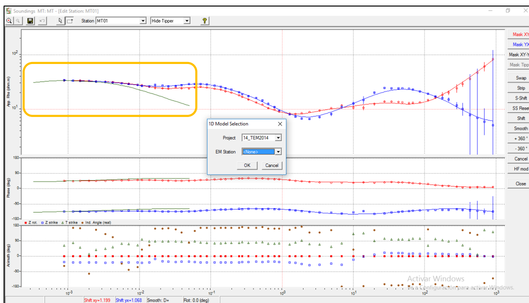
Figura 6.5 Ajuste de curva TDEM para corrección de static shift.
