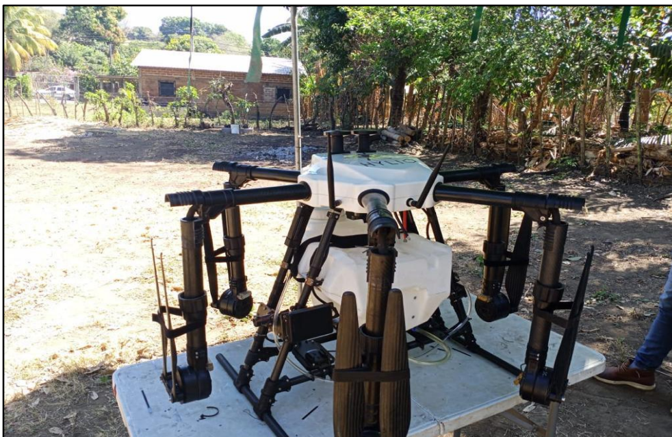
Imagen 13. VANT Hylio® AG116 descargado y listo para plegar brazos y armar helices.
