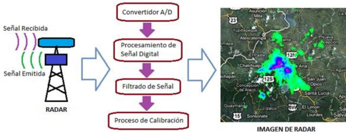
Figura 1.5.5 2: Esquema del proceso general para la producción de imágenes de radar.
