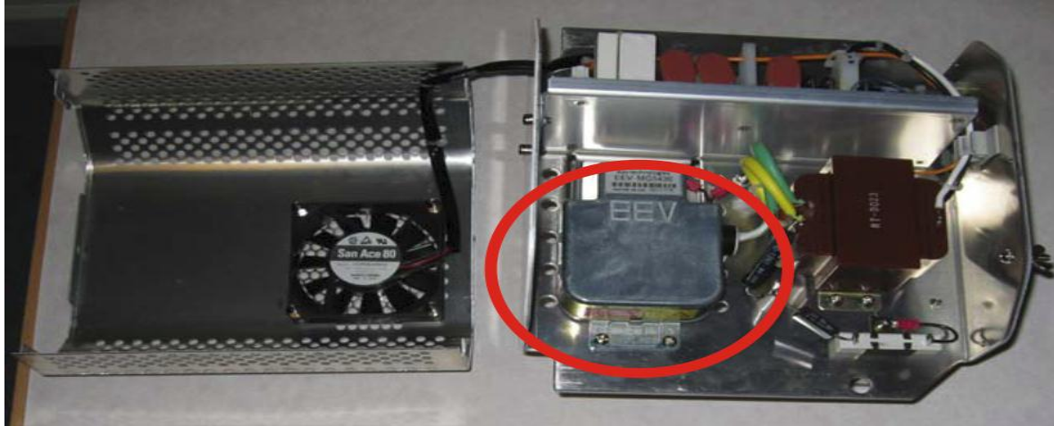
Figura 2.1.2: Fotografía que muestra la ubicación del magnetrón en el transceptor.
