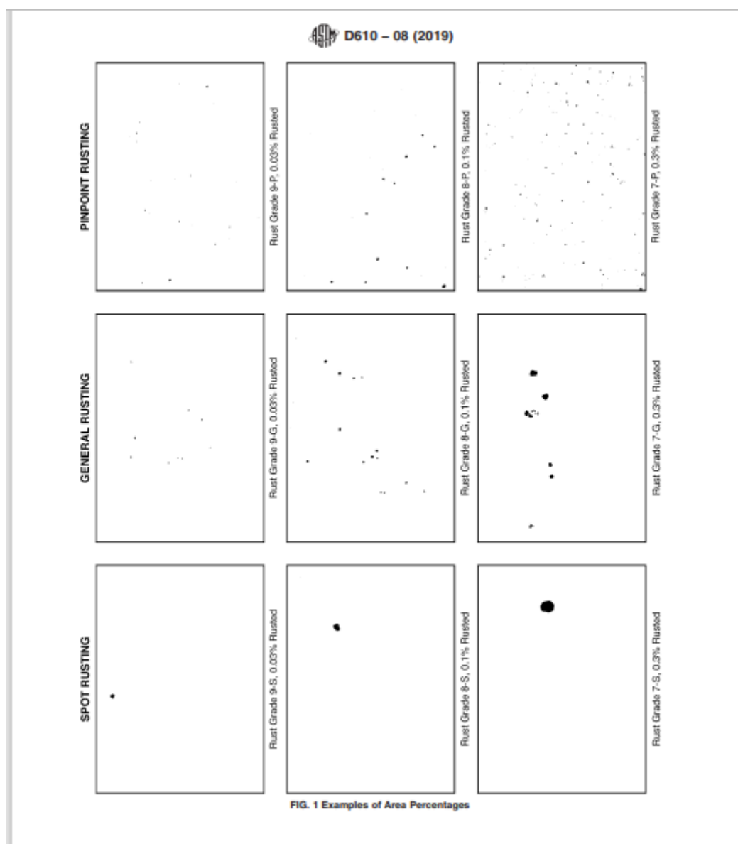
Figura A.1 Patrón para evaluación visual de corrosión en láminas con recubrimiento Fuente: ASTM D610-08,2019
