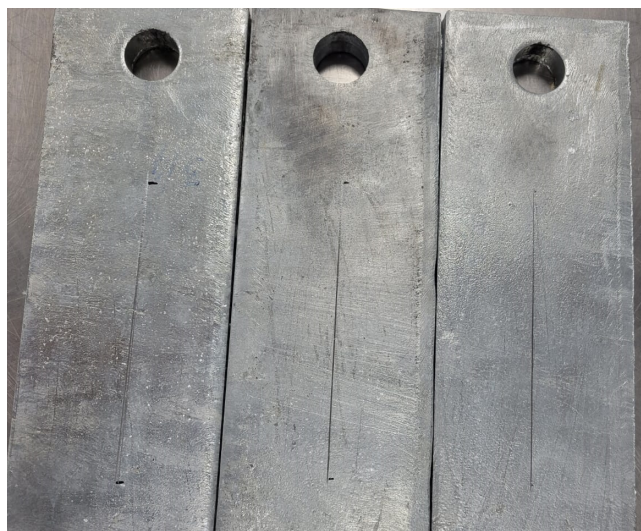
Figura 3-11 Incisión en la muestra
