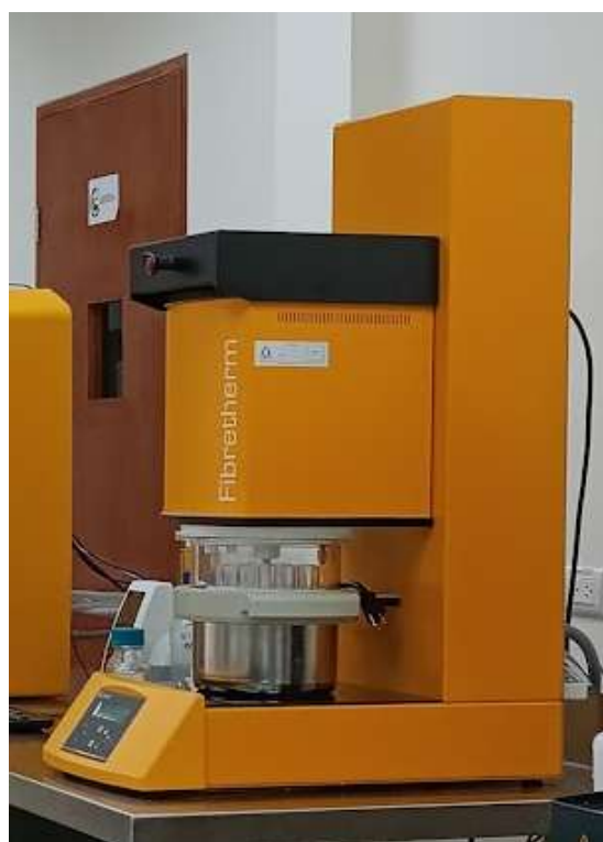
Anexo 9 Digestor Fibertherm
