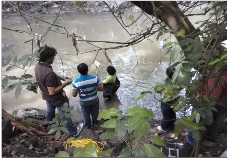
Punto detector en estudio de dispersión, utilizando sal común como trazador
