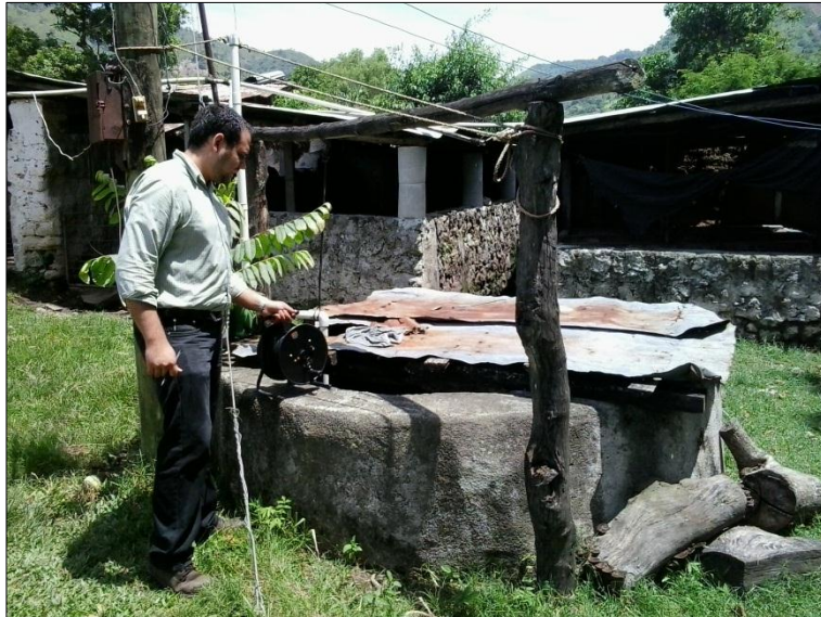
Medición de niveles piezométricos en pozos
