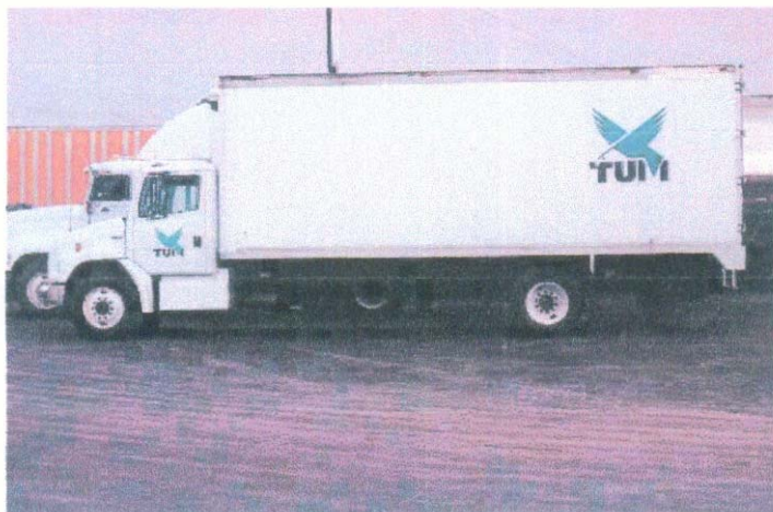
Anexo 2-1 Configuración de vehículo C2 (eje delantero sencillo y trasero dual)
