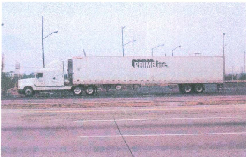
Anexo 2-3 Configuración de vehículo T3-S2 (eje delantero sencillo y traseros duales en el tractocamión y ejes duales en el semiremolque)
