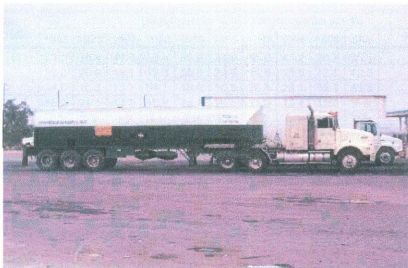
Anexo 2-4 Configuración de vehículo T3-S3 (eje delantero sencillo y traseros duales en el tractocamión y ejes duales en el semiremolque)
