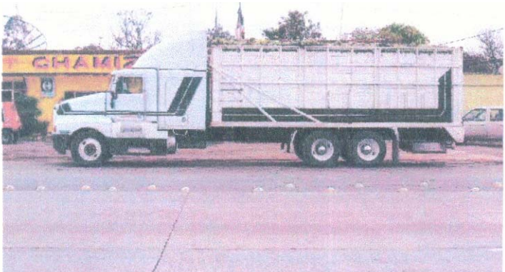
Anexo 2-2 configuración de vehículo C3 (eje delantero sencillo y traseros duales)
