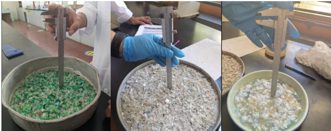
Figura 18. Medición de grosor de capa de la distribución de PET en la bandeja de metal
