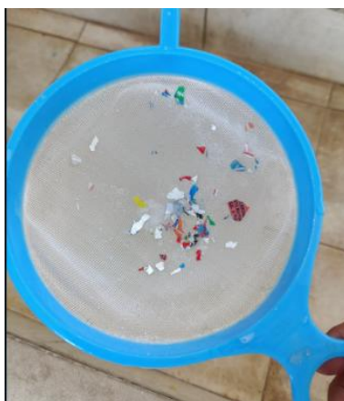
Figura 13. Sólidos que se retiraron del lavado (plástico, etiquetas, PET con pegamento)
