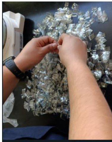
Figura 2. Colocación de muestras de PET en mesa de trabajo previo a la inspección visual
