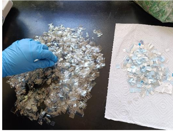
Figura 4. Separación de PET que contiene etiqueta o pegamento de la botella
