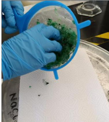
Figura 14. Colocación de PET en toalla de absorción que a su vez esta sobre una bandeja de metal
