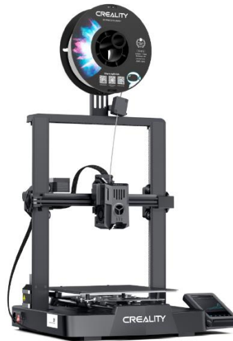
Figura 6.10. Impresora Creality-Ender 3 V3 KE 22 x 22 x 24 cm. Fuente: (Creality, n.d.)
