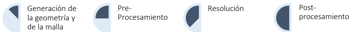
Figura 4.2. Etapas para la solución de un problema mediante CFD. Fuente: Elaboración propia.
