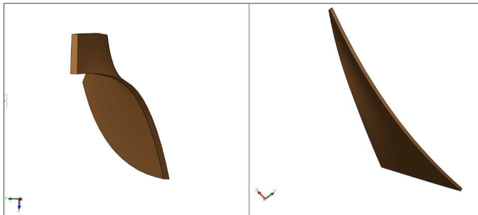
Figura 4.16. Vista en isométrico y proyección ortogonal del álabe modificado en Ansys. Fuente: Obtenido de Ansys.
