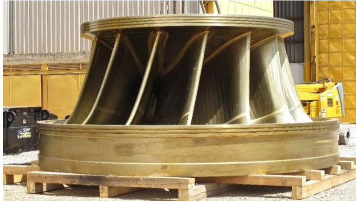
Figura 1.19. Rodete de una turbina Francis.
