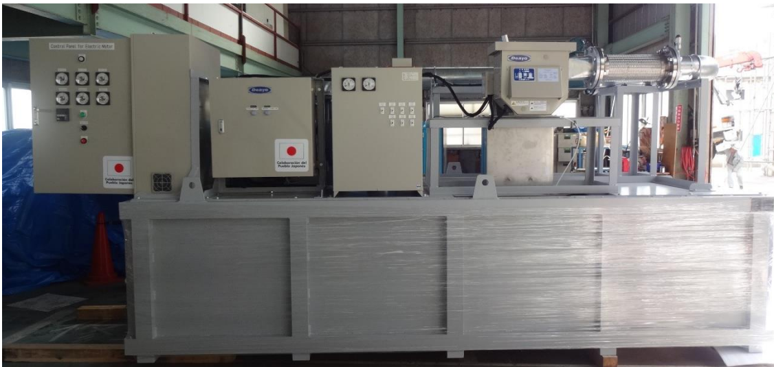
Figura 2.1. Banco de Pruebas para Pequeña Central Hidroeléctrica de la Escuela de Ingeniería Mecánica. Fuente: (UNIDO, 2018)
