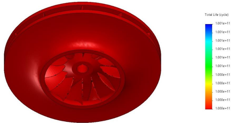
Figura 5.26. Simulación por fatiga del rodete: Vida total. Fuente: Elaboración propia.
