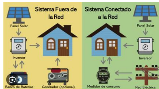
Figura 8. Diferencias del sistema off-gride y on-grid
