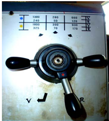
Figura 4.1 Disposición de las palancas en la caja de velocidades del torno, para generar 50 rpm.
