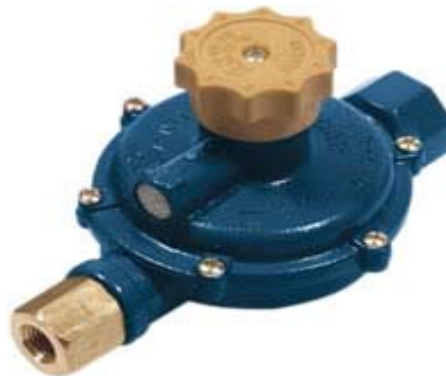
Figura 3.1. Regulador de única etapa de presión graduable para el manejo de propano. Diseñado para trabajo tipo industrial como lámparas infrarrojas de gas, sopletes, hornos, incubadoras, etc. Donde la capacidad instalada requiera ajustes continuos en la presión de consumo entre 6.9 - 13.8 Kpa (1-2 psi)
