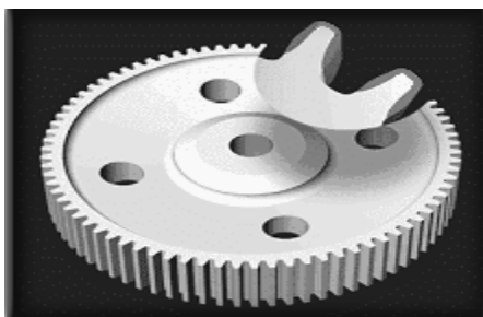
Figura 1.8 Ampliación del efecto de endurecimiento en la superficie de los dientes de un engrane [www.cflame.com].
