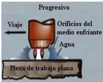
Figura 1.3 Método de temple por flama progresivo [www.flametreatingsystems.com]
