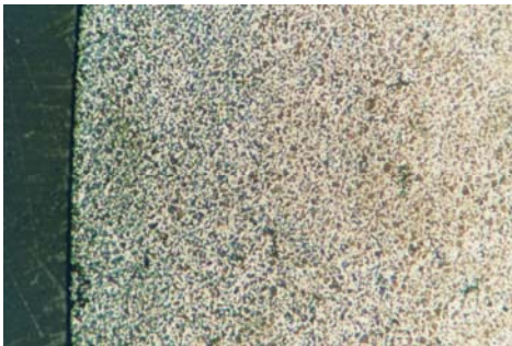
Figura 3.27. Microestructura de la superficie en una barra de ½ pulg, de acero AISI 1045, sometido a tratamiento superficial de temple en el horno, Las condiciones del tratamiento son: temperatura del horno 900 °C, tiempo de mantenimiento en el interior del horno de la probeta 2 minutos, el medio de enfriamiento es agua a temperatura ambiente de 32 °C (100×).
