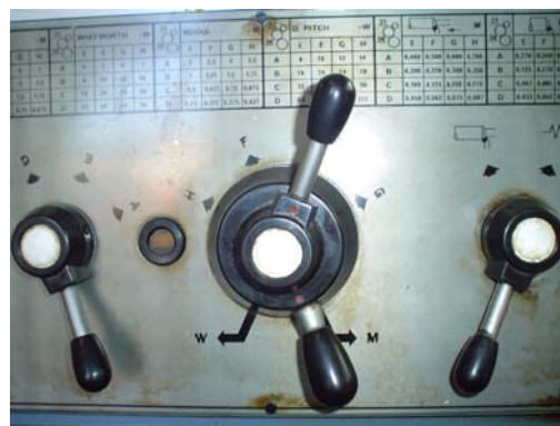
Figura 4.3 Disposición de las palancas del sistema de control del tornillo patrón del torno utilizado para las pruebas de temple por flama.
