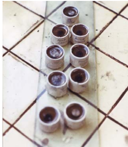
Figura 3.5 Probetas embutidas en resina poliéster.
