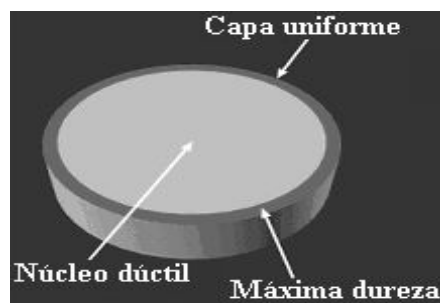
Figura 1.9 Efecto del endurecimiento rotatorio, señalando un núcleo tenaz y la superficie endurecida [www.cflame.com].
