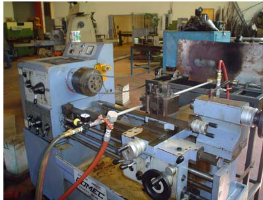
Figura 4.9 Sistema de temple por flama acoplado a un torno. Al fondo se puede observar el banco de pruebas en donde es colocada el espécimen a templar. Montado en el portaherramientas se encuentra la boquilla tipo soplete.
