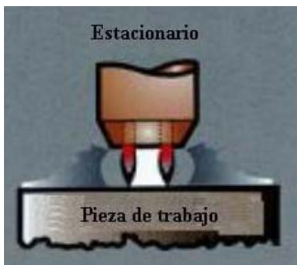
Figura 1.1 Método de temple por flama estacionario [www.flametreatingsystems.com]
