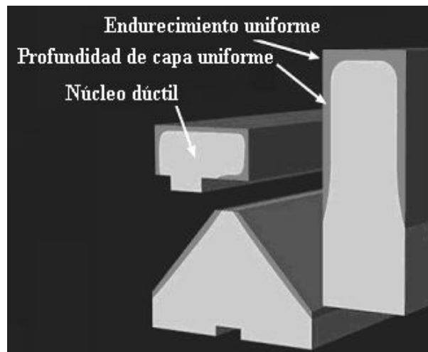
Figura 1.5 Características de la capa endurecida por el método progresivo[www.cflame.com]
