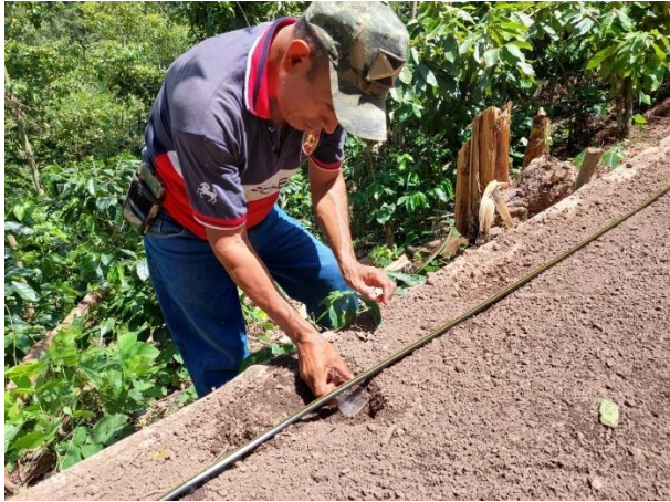
Imagen 7. Medición de aforo del sistema de riego, Cantón Capucalito, La Unión, GT.
