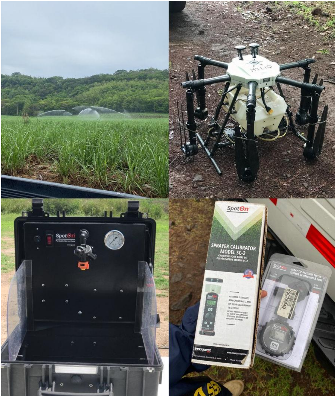
Figura 6. Identificación de instrumentos y equipo en campo en la hacienda “El cacao” Nahulingo. Sonsonate. VANT Hylio AG-116
