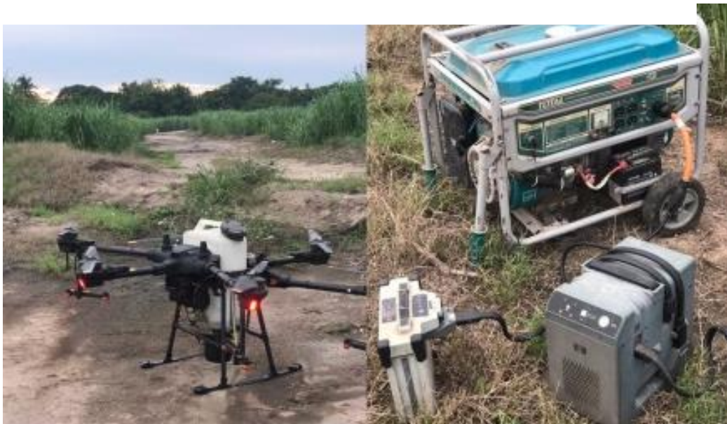
Figura 27. Equipo VANT DJI AGRAS T20 utilizado en la operación con planta eléctrica para recargar baterías de dron en hacienda Amatecampo, con empresa prestadora de servicio SADSUR S.A DE C.V
