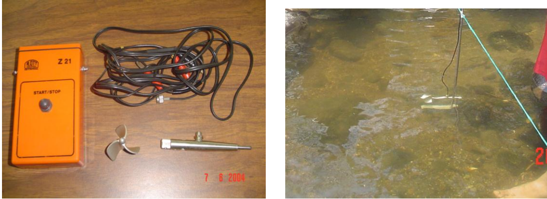
Fig. 6.1 Partes de un molinete (electrodo, propela, trasductos,) y molinete armado para la medición en el cauce del río.
