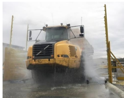
Figura 14. Sistema de rocío para limpieza de camiones
