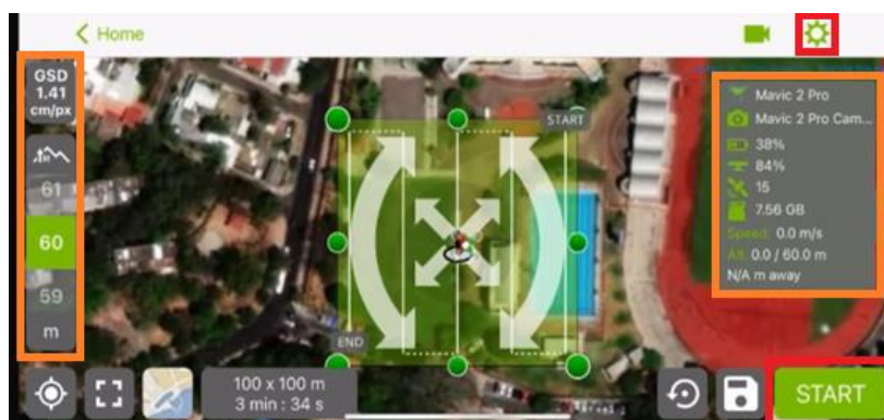
Imagen 3-20: Interfaz de PIX4D, configuración de la altura de vuelo, GSD y datos del dron (lado derecho); captura de pantalla tomada como referencia durante clases prácticas del curso de especialización.
