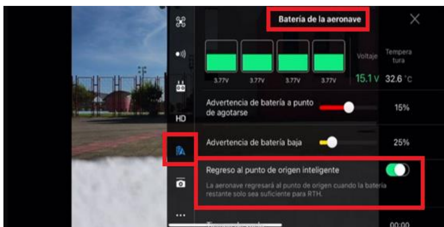
Imagen 3-16: Configuración de la batería de la aeronave; captura de pantalla tomada como referencia durante clases prácticas del curso de especialización.
