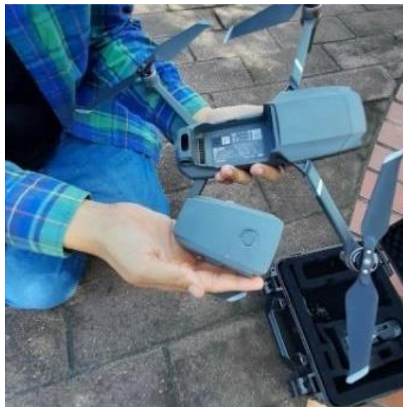
Imagen 3-10: Insertando la batería en el dron; foto tomada como referencia durante clases prácticas del curso de especialización.
