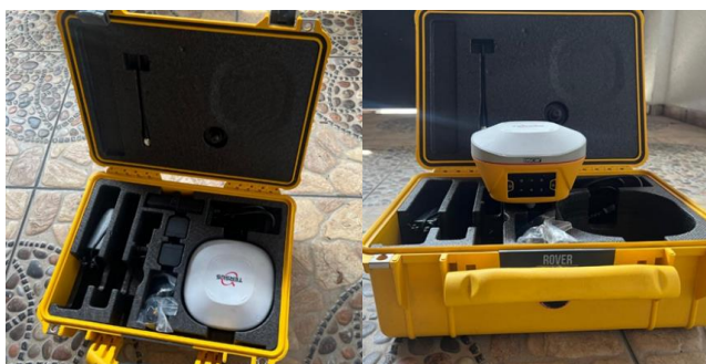
Imagen 3-3: Receptor Móvil Tersus Oscar Advance y sus componentes en su maletín; foto tomada para referencia.
