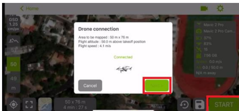
Imagen 3-22: Botón de START y ventana de conexión entre el dron y el control remoto (teléfono móvil); captura de pantalla tomada como referencia durante clases prácticas del curso de especialización.
