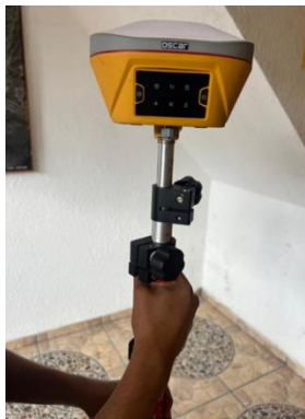
Imagen 3-4: Enroscando el receptor móvil al bastón, foto tomada para referencia.
