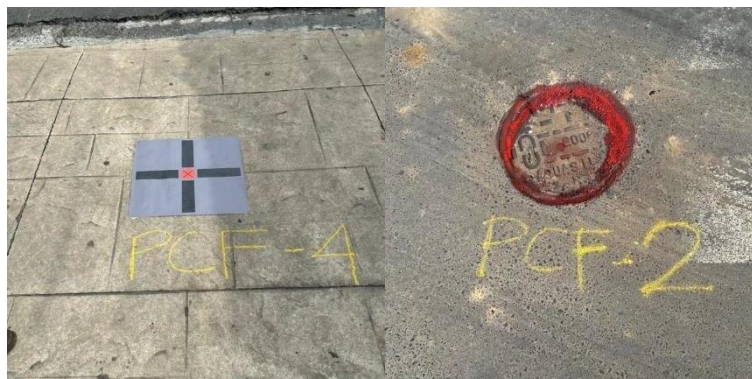
Imagen 3-2: Identificación de PCF para poder ser observados con el dron.
