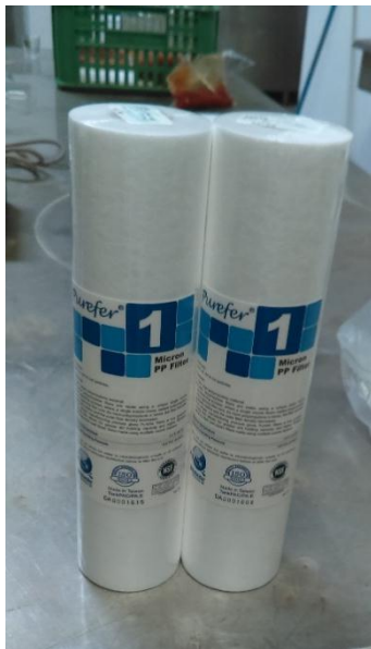
Figura 7 y Figura 8: se puede observar los filtros utilizados en la práctica de filtración mecánica la figura 6 ya están listos los filtros y colocados en fila para hacer circular el líquido.
