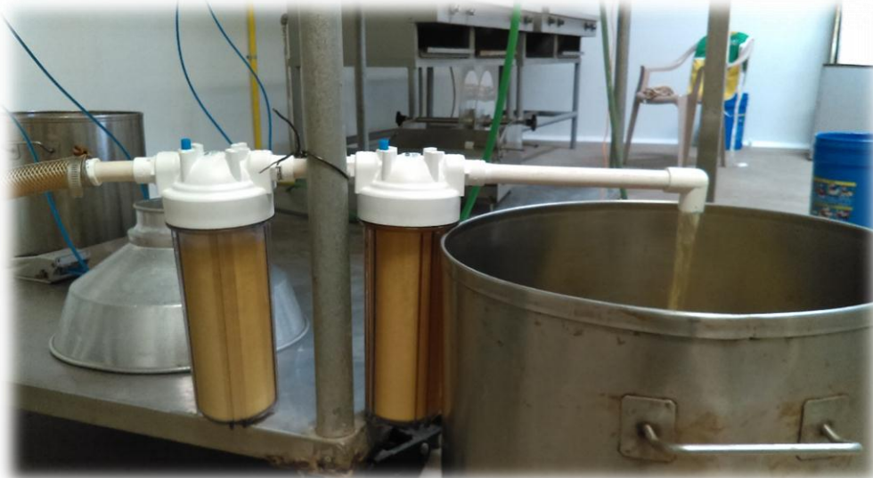
Anexo 4. Filtración mecánica de vino de marañón
