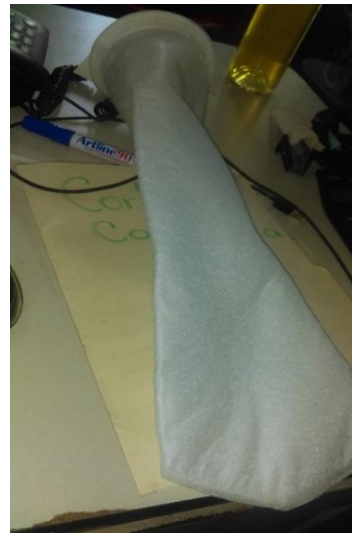
Figura 4 y Figura 5: Se muestra un filtro tipo manga de pp de 50 micrones de espacio de filtrado
