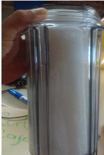
Figura 6: Se muestra una carcasa que es la que protege del exterior al filtro purificador de pp.
