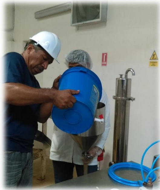
Anexo 3. Vertido de vino en alimentador de la batería de filtros de pp.
