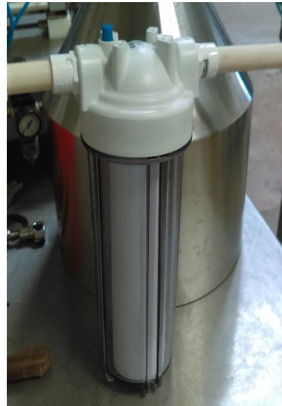
Figura 7 y Figura 8: se puede observar los filtros utilizados en la práctica de filtración mecánica la figura 6 ya están listos los filtros y colocados en fila para hacer circular el líquido.
