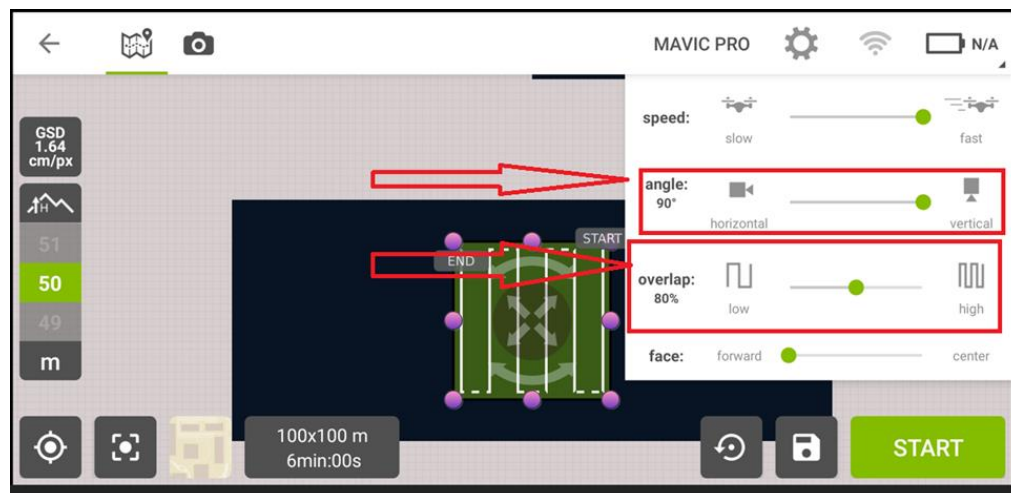
Figura No. 55. Verificar el ángulo de la cámara y el traslape a utilizar. Fuente: Elaboración propia.
