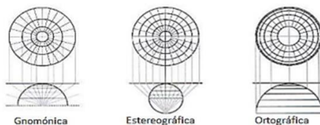
Figura No. 13. Proyecciones planas con diferente punto de perspectiva. Fuente: (Ronaldo, 2015)
