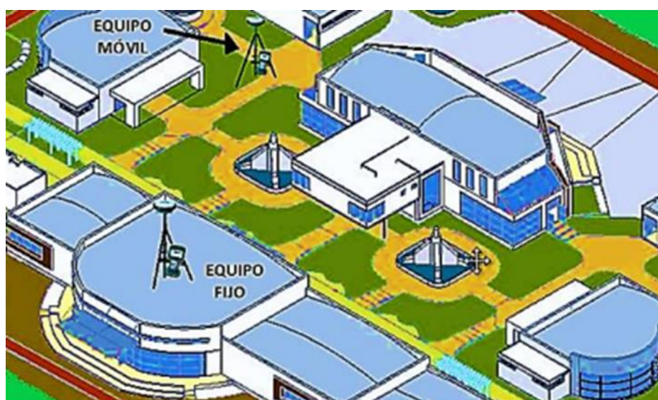
Figura No. 31. Ubicación recomendada para receptor Base y Móvil en técnica RTK. Fuente: (Amaya, 2021)
