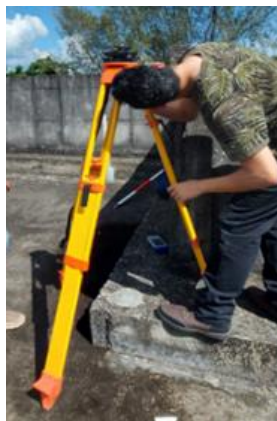
Figura No. 45. Centrado de trípode y nivelación. Fuente: Elaboración propia.
