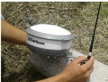
Figura No. 47. Colocación de antena. Fuente: Elaboración propia.
