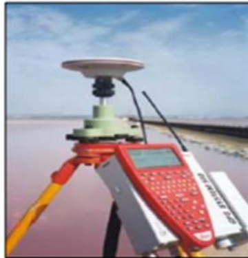
Figura No. 29. Receptor BASE y MOVIL de GPS geodésico de una frecuencia. Fuente: (Amaya, 2021)
