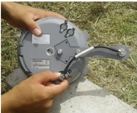
Figura No. 46. Acople de extensión de antena a receptor. Fuente: Elaboración propia.
