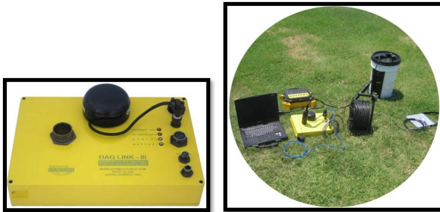
Figura 3.1. (izquierda) DAQlink 3 System 24-bits sistema adquisidor, (derecha) componentes básicos de un DAQlink System.
