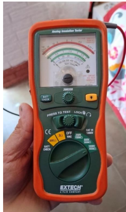
Imagen 6. Megóhmetro analógico para alto voltaje marca EXTECH, modelo 380320.
