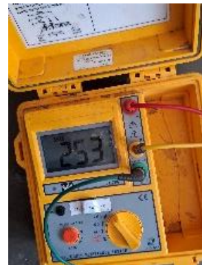
PRUEBA DE RED DE TIERRA: Valor de resistencia de tierra fuera de norma.
