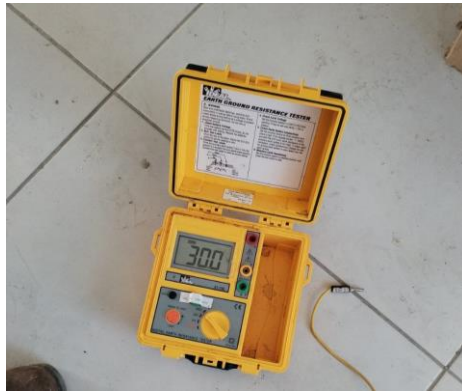
PRUEBA DE RED DE TIERRA CON OHMIAJE ALTO NO CUMPLE
