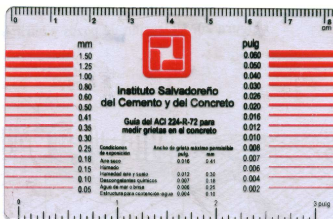
Figura N° 3.26: Grietómetro para medir anchos de grietas.
