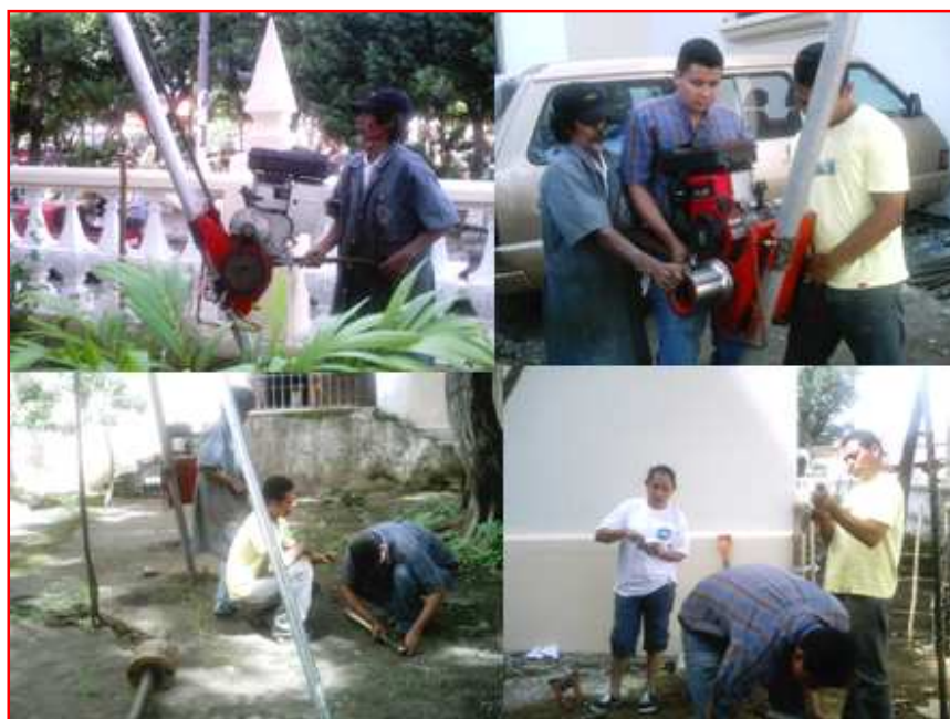
Figura 4.18; Grupo de Trabajo de Graduación Realizando la Prueba SPT, en Catedral Basílica de Nuestra Señora de la Paz.
