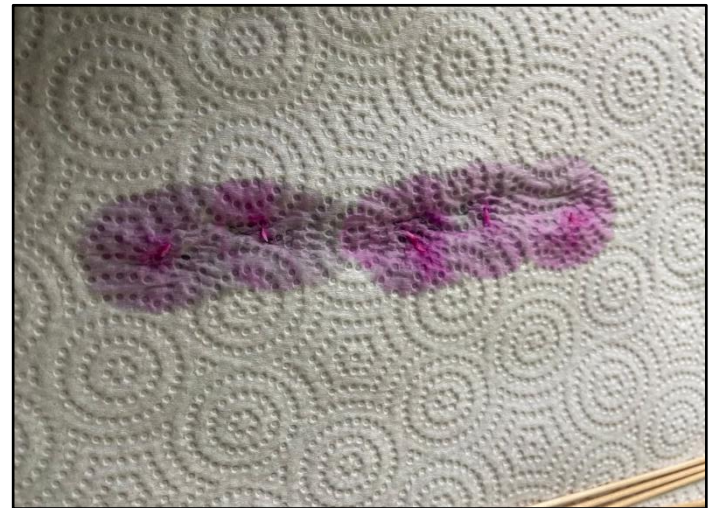
Figura 2. Prueba de Fenolftaleína color rosado brillante nos da un resultado positivo, lo que indica presencia de sangre.
