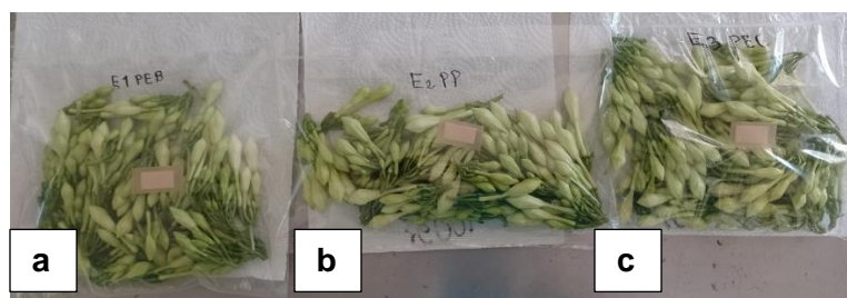
Figura 15. Asignación e identificación de tratamientos, a) T1: Polietileno Biorientado (PEB), b) T2: Polipropileno (PP), c) T3: Polietileno Baja Densidad (PEBD).
