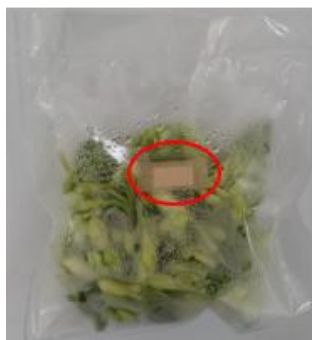
Figura 19. Venda adhesiva colocada a los empaques plásticos para introducir el sensor del equipo medidor de gases.
