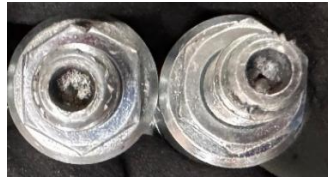
Figura 97. Fresado hexagonal del tornillo de ajuste de las válvulas RV3-10
