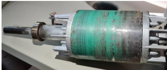
Figura 146. Rotor desacoplado del motor eléctrico
