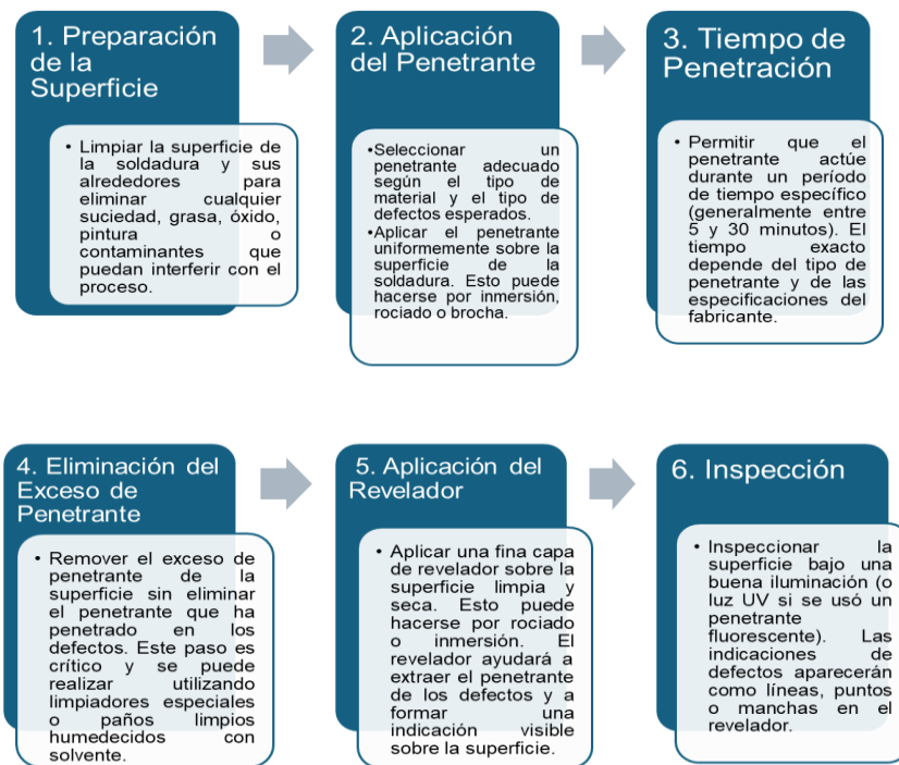
Figura 48. Procedimiento para seguir en un ensayo de líquidos penetrantes
