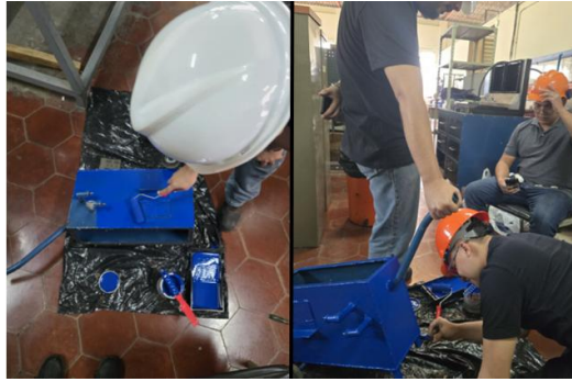
Figura 164. Pintado del tanque de aceite hidráulico
