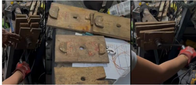
Figura 151. Moldes para fabricación de bobinas
