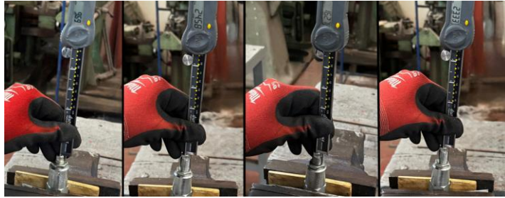
Figura 96. Recorrido de las válvulas RV3-10 Y de la RV2-10
