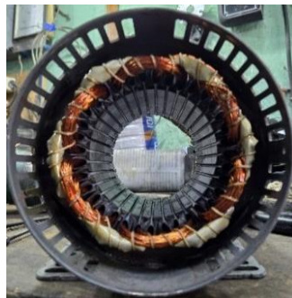
Figura 154. Estator con bobinado nuevo
