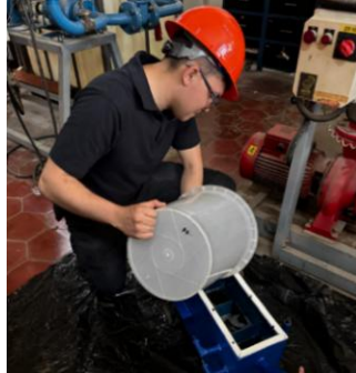
Figura 197. Trasiego del aceite hidráulico hacia el tanque
