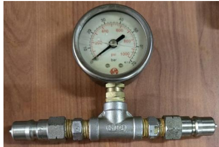
Figura 181. Desinstalación de manómetro ubicado en un conector en T
