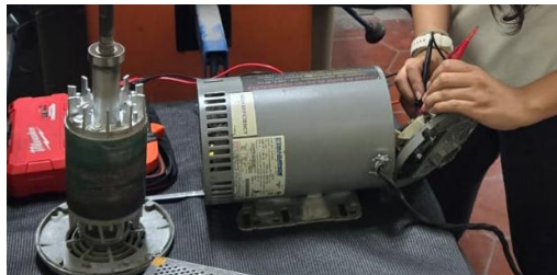
Figura 58. Medición respecto a tierra
