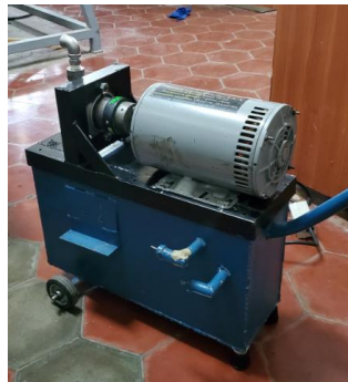
Figura 198. Tanque de aceite con el motor, la bomba y el acople instalados
