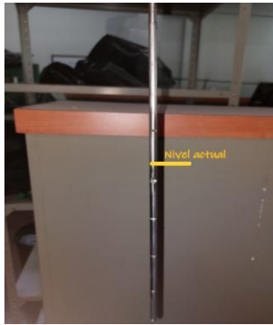
Figura 68. Medición del nivel de aceite con la bayoneta
