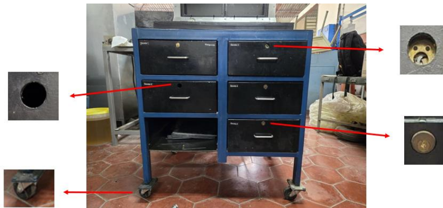
Figura 90. Cerraduras en mal estado y ruedas con resequeadad
