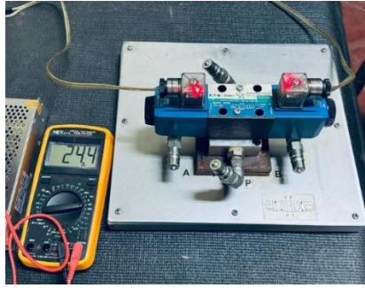
Figura 121. Medición del voltaje de salida con el equipo conectado
