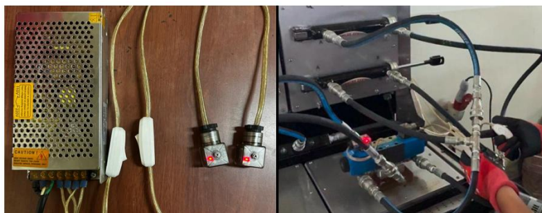
Figura 208. Puesta en marcha de la fuente CD
