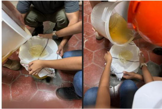
Figura 72. Trasiego y filtrado de aceite hidráulico
