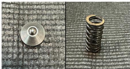
Figura 94. Obturador y resorte de la válvula piloto de la válvula RV2-10
