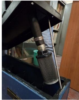
Figura 80. Desmontaje y desconexión del filtro de aceite
