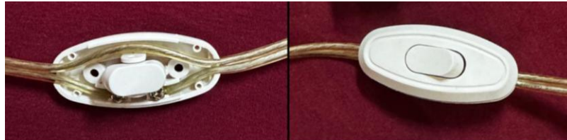
Figura 172. Instalación de interruptores en el cableado de salida de la fuente CD
