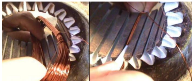
Figura 153. Montaje de grupo de bobinas
