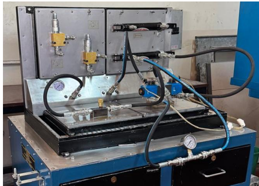
Figura 240. Construcción del circuito hidráulico de la práctica N°4
