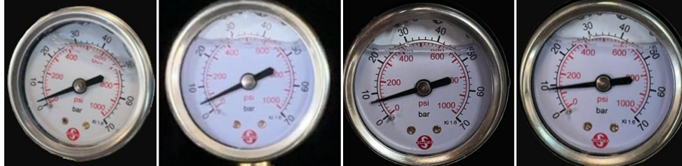
Figura 216. Presiones de ajuste de las válvulas limitadoras de presión
