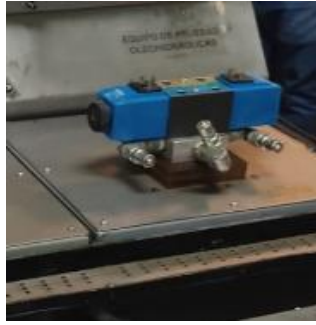
Figura 109. Módulo de control direccional del equipo de oleohidráulica
