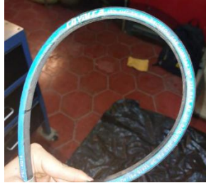
Figura 124. Prueba de rigidez de las mangueras hidráulicas
