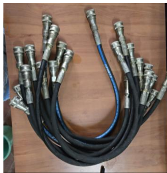
Figura 41. Mangueras hidráulicas del equipo de oleohidráulica
