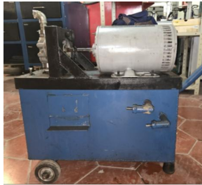
Figura 30. Tanque de aceite del equipo oleohidráulico
