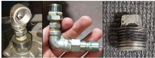
Figura 135. Desmontaje y desconexión de los accesorios de interconexión
