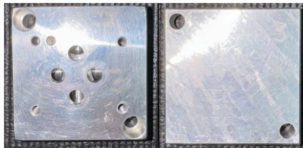
Figura 129. Rayones superficiales en la parte externa de la placa base
