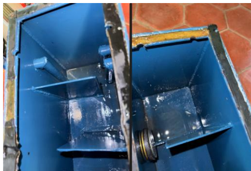
Figura 73. Inspección de las placas separadoras del tanque de aceite hidráulico
