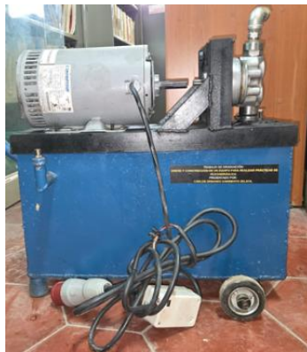
Figura 50. Motor trifásico MARATHON ELECTRIC 1.5 hp 6 Polos
