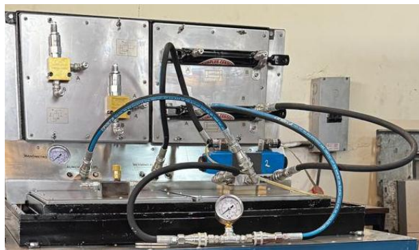
Figura 218. Circuito para prueba 3 funcionamiento electroválvula
