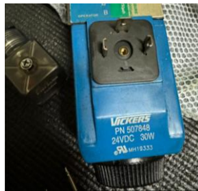
Figura 115. Se desconecta la fuente de poder de la electroválvula
