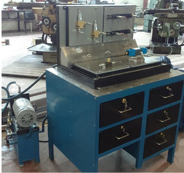
Figura 26. Equipo para realizar prácticas de oleohidráulica (Sarmiento, 2016)
