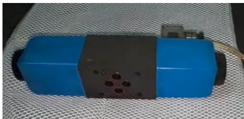
Figura 116. Terminal derecho de la electroválvula conectada a la fuente de poder
