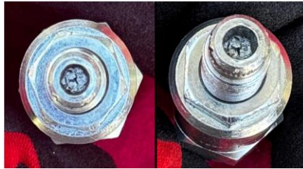
Figura 178. Desgaste del hexágono del tornillo de ajuste de las válvulas de control de presión RV2-10
