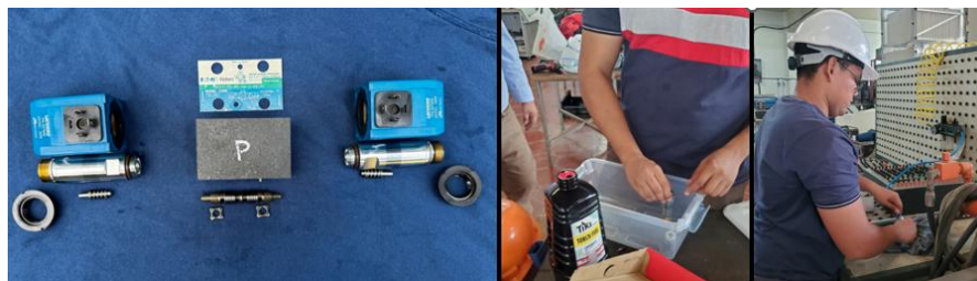
Figura 207. Desarme y limpieza de componentes de la electroválvula
