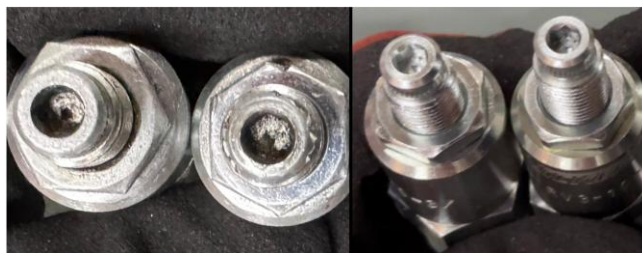
Figura 179. Comparación de los hexágonos de las válvulas originales y de las nuevas
