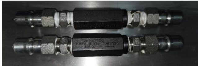
Figura 104. Estado inicial de las válvulas antirretorno
