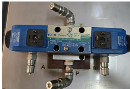
Figura 111. Revisión de las conexiones de la electroválvula
