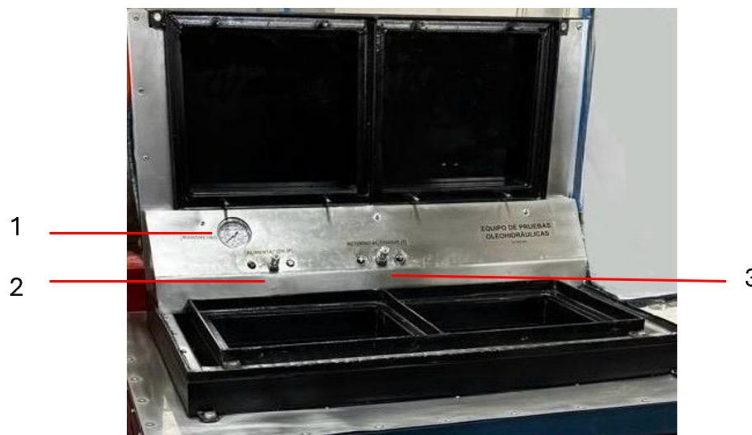
Figura 227. Ubicación de los componentes del tablero oleohidráulico
