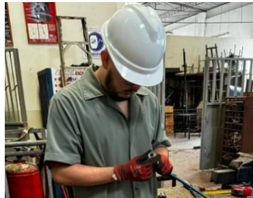
Figura 175. Limpieza de mangueras y conexiones
