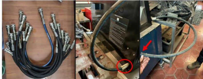
Figura 122. Inspección visual general de manguera hidráulicas
