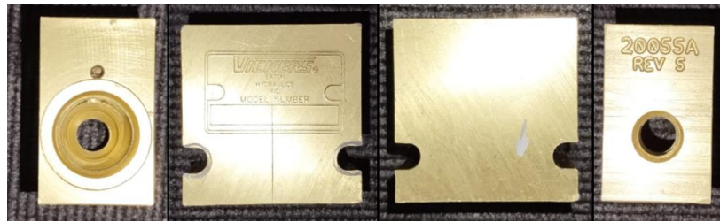
Figura 131. Limpieza exterior e interior de los bloques manifold
