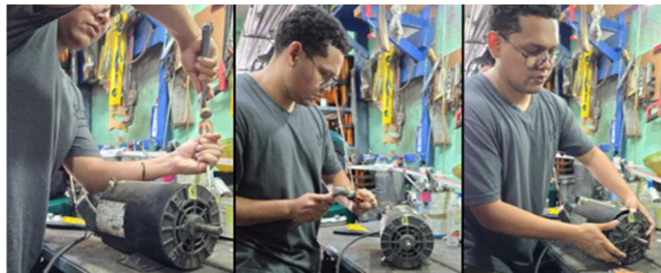
Figura 145. Desmontaje de tapas frontal y trasera
