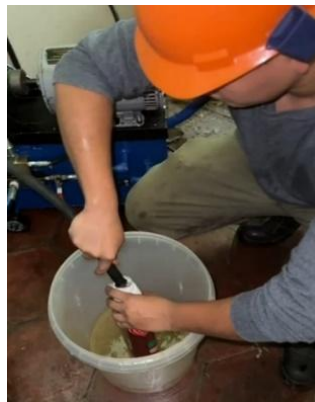
Figura 196. Recolección de aceite hidráulico para el cálculo de caudal suministrado
