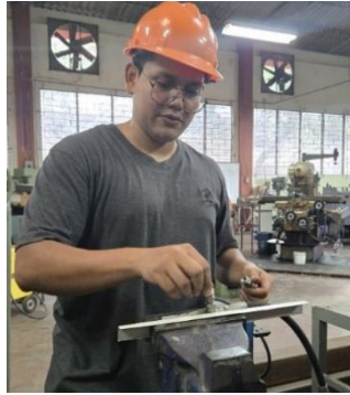
Figura 174. Desmontaje de acoples rápidos NPTF y accesorios de interconexión
