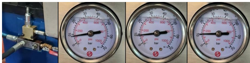
Figura 204. Apertura de la nueva válvula de alivio en circuitos conectados al tanque y de bloqueo
