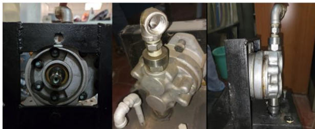
Figura 62. Desmontaje y desconexión de la bomba hidráulica
