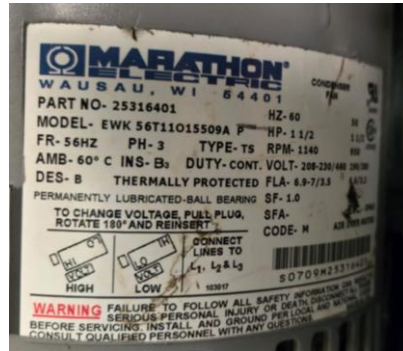
Figura 51. Placa de datos técnicos, motor trifásico
