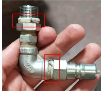
Figura 137. Exceso de cinta selladora en accesorios de interconexión
