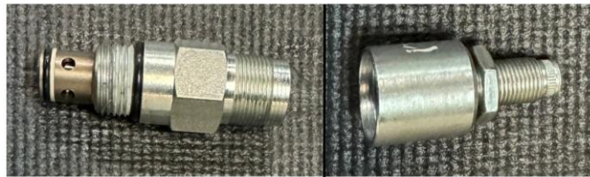
Figura 93. Desacople de las válvulas y revisión de uniones
