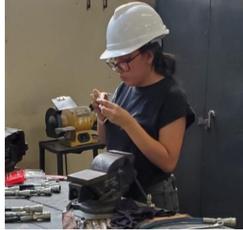
Figura 176. Colocación de cinta selladora de teflón
