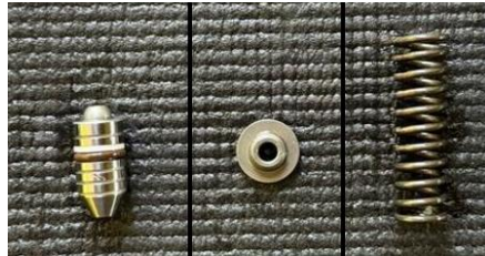
Figura 95 . Revisión de componentes internos de las válvulas RV3-10
