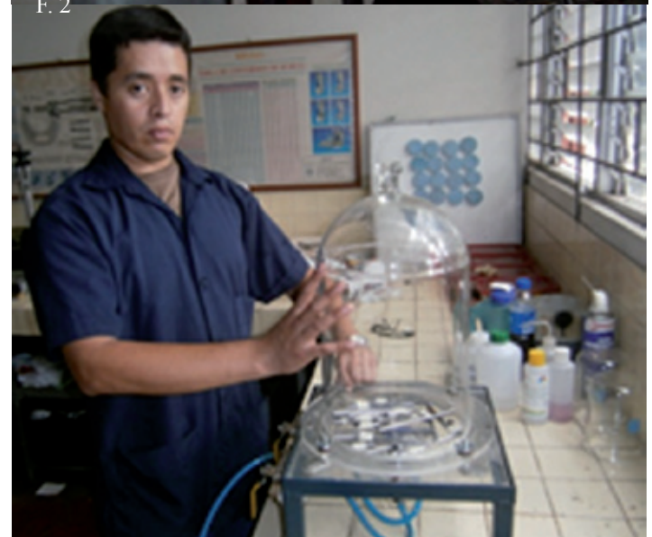
▲ F.1, Tratamiento térmico de recocido en una cámara de gases inertes F.2. Almacenamiento de probetas ensayadas a fatiga.
