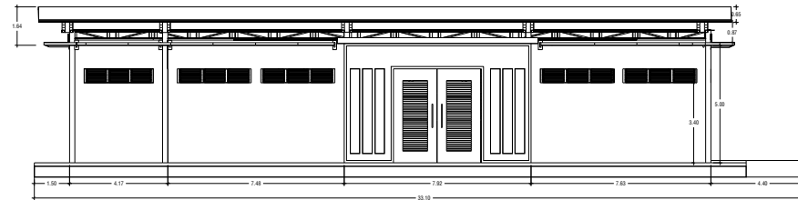
ELEVACION NORTE DE TALLER DE ELECTRICIDAD ESCALA 1:100
