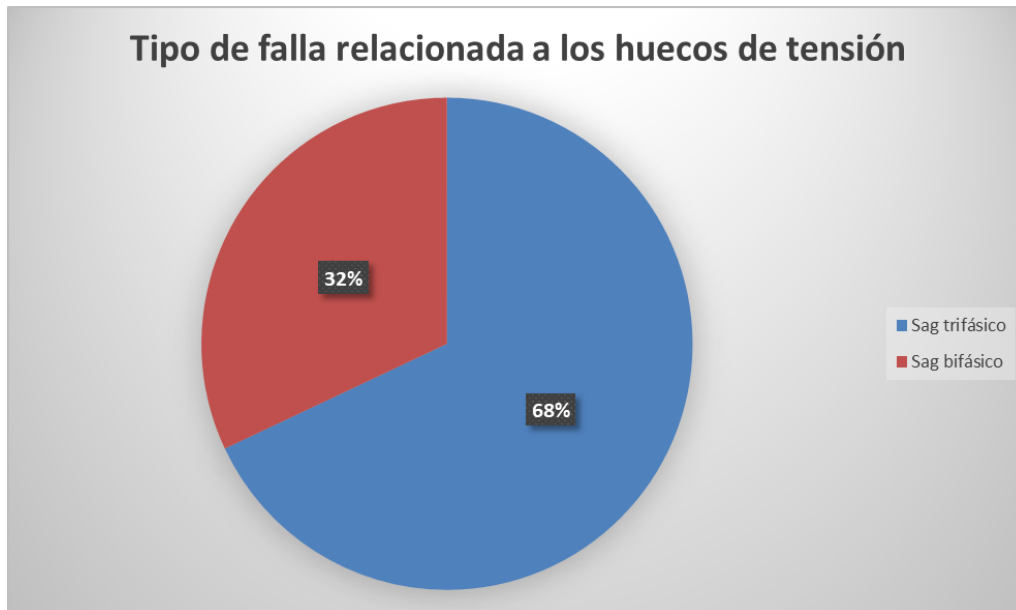
Figura 29. Proporción del tipo de falla relacionada a los huecos de tensión en el edificio de servicios corporativos.
