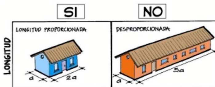
Figura 34: Relación entre largo y ancho de una vivienda de un solo piso (Asociación Colombiana de Ingeniería Sísmica, 2000).
