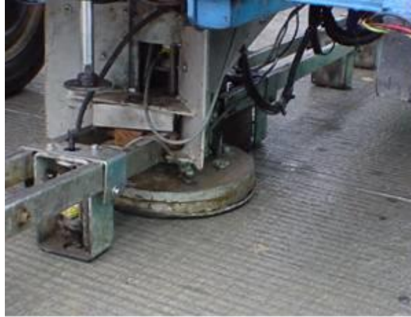
Figura 10: Placa de carga en forma de plato de FWD. Fuente: Technology and Management Limited (TNM).
