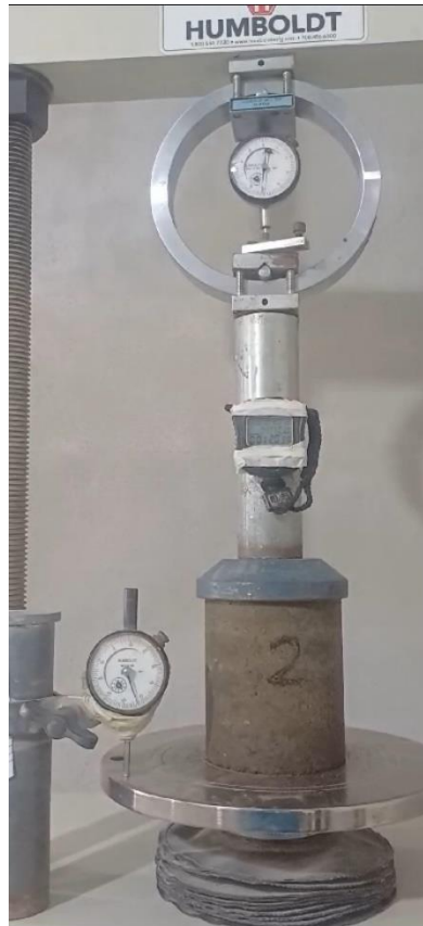
Figura 19: Ensayo de Compresión sin confinar en TPLAB. Fuente: TPLAB, S.A. de C.V.
