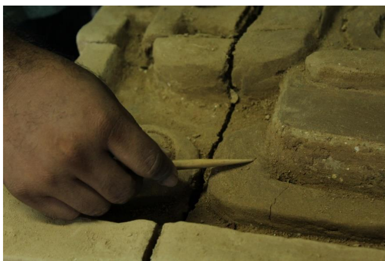
Fig 51. Corte para generar relieve en ladrillo. Fotografía: Grupo investigador
