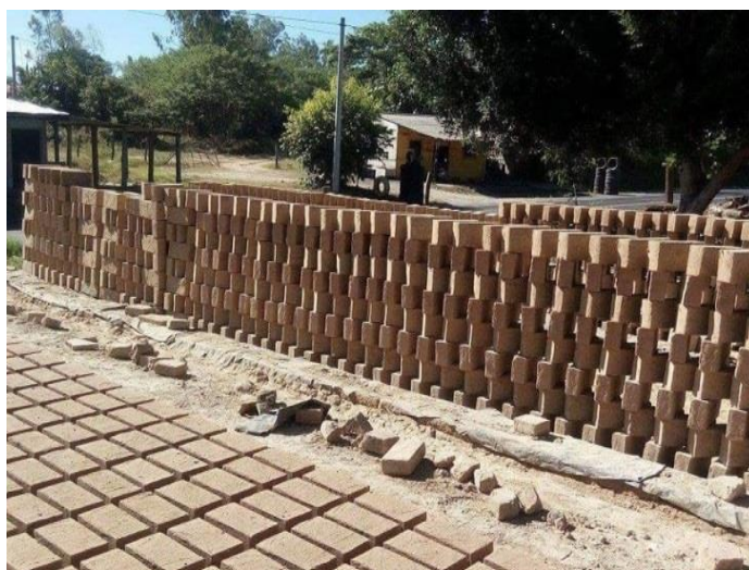
Fig. 33 – Secado de ladrillos en trincheras. / Fotografía por grupo investigador
