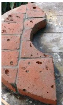
Fig. 38 – Detalle de proceso agujeros en piezas cocidas. / Fotografía por grupo investigador.
