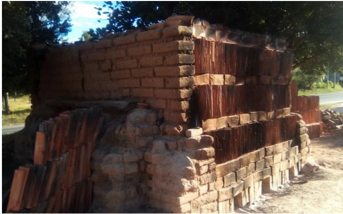
Fig. 35 – Horno cargado en enfriamiento.
