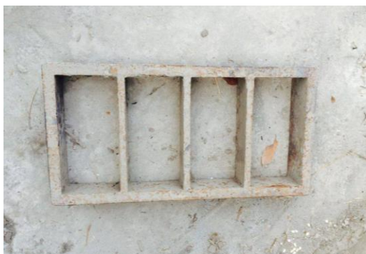
Fig. 29 – Modelado de ladrillos con gradilla. Fotografía por grupo investigador
