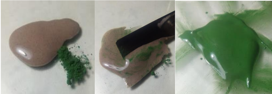
Fig. 48 – Mezcla de arcilla y óxido colorante. / Fotografía por grupo investigador.
