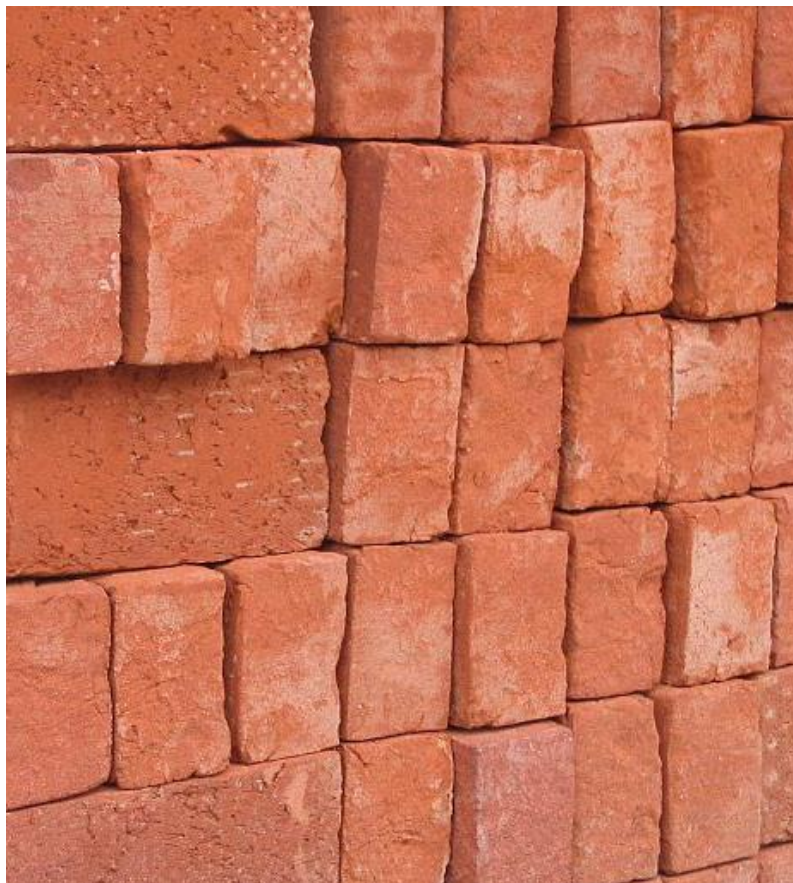
Fig. 18 – Detalle de apilamiento de ladrillos cocido. / Fuente: Fuente: Gordon derivative work es.wikipedia.org
