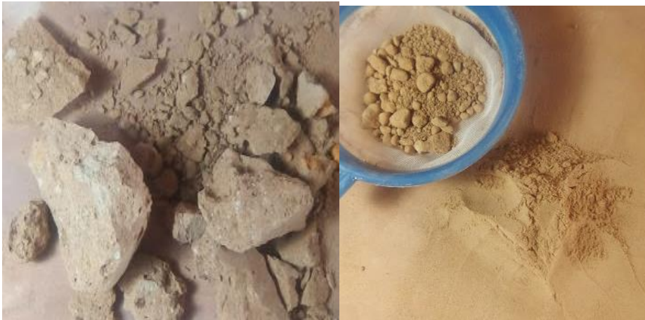
Fig. 46 – Pulverización y tamizado de ladrillo seco para elaborar engobes. / Fotografía por grupo investigador.
