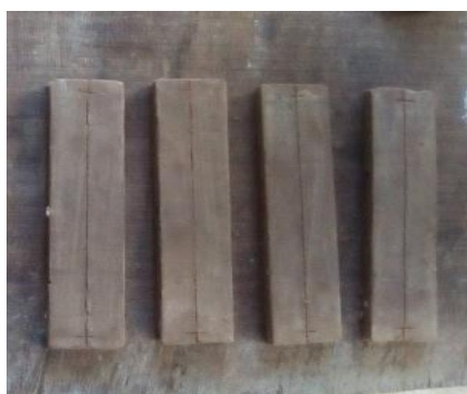
Fig. 37 – Elaboración de tejas de ensayo en estado crudo. / Fotografía: Grupo investigador.
