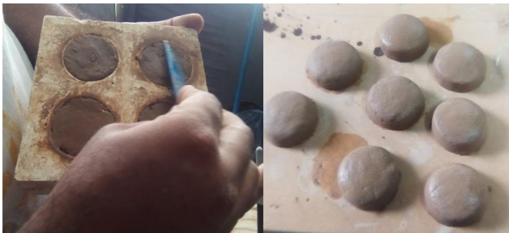
Fig. 50 – Elaboración de tejas de ensayo para engobes. / Fotografía por grupo investigador.
