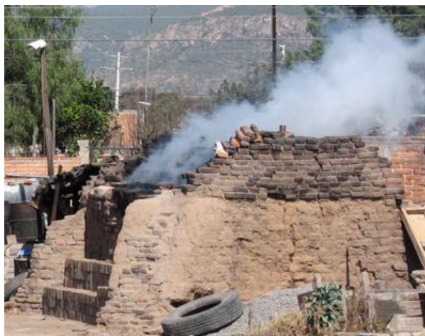
Fig. 34 – Horno cargado en cocción. / Fotografía por grupo investigador
