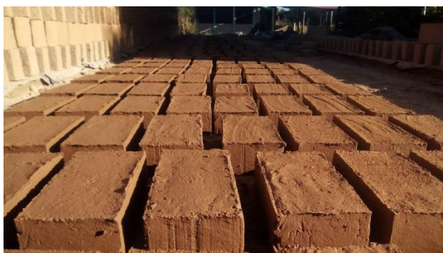
Fig. 32 – Secado de ladrillos en suelo. / Fotografía por grupo investigador
