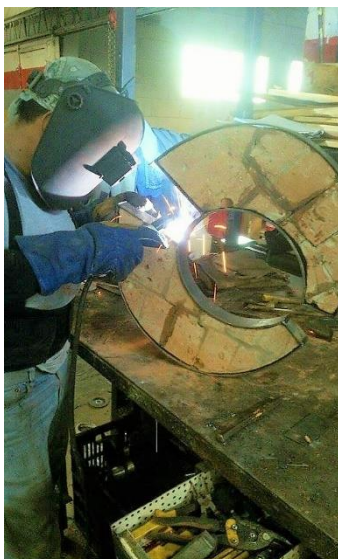
Fig 53. Ensamblaje de platina. Fotografía: Grupo investigador.
