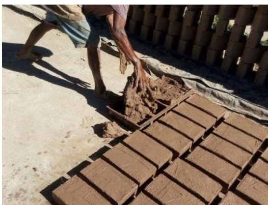
Fig. 31 – Modelado de ladrillos en gradilla. / Fotografía por grupo investigador
