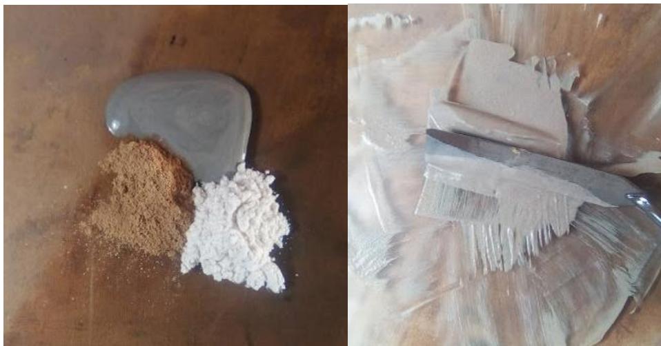
Fig. 47 – Mezcla de ball-clay, arcilla de ladrillo y talco. / Fotografía por grupo investigador.
