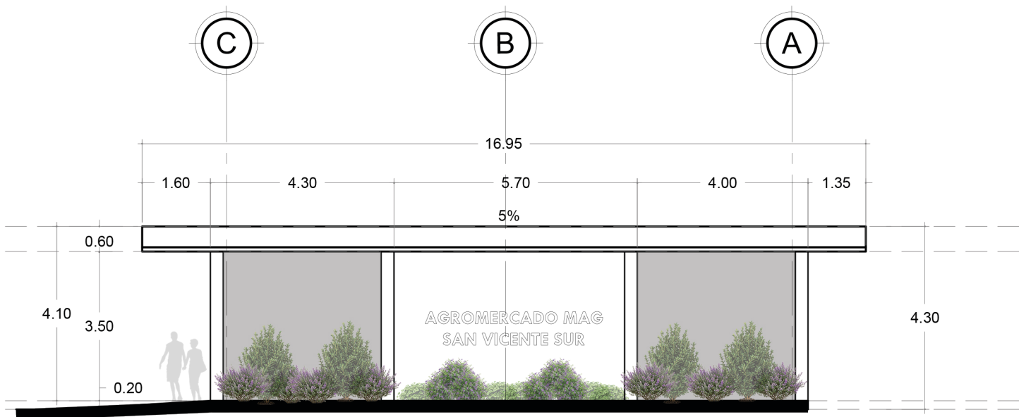
ELEVACIÓN DE FACHADA ORIENTE ESC 1:125
