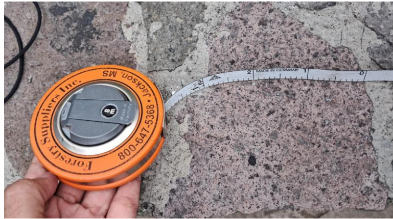
Figura 7. Cinta diamétrica para medición de DAP.
