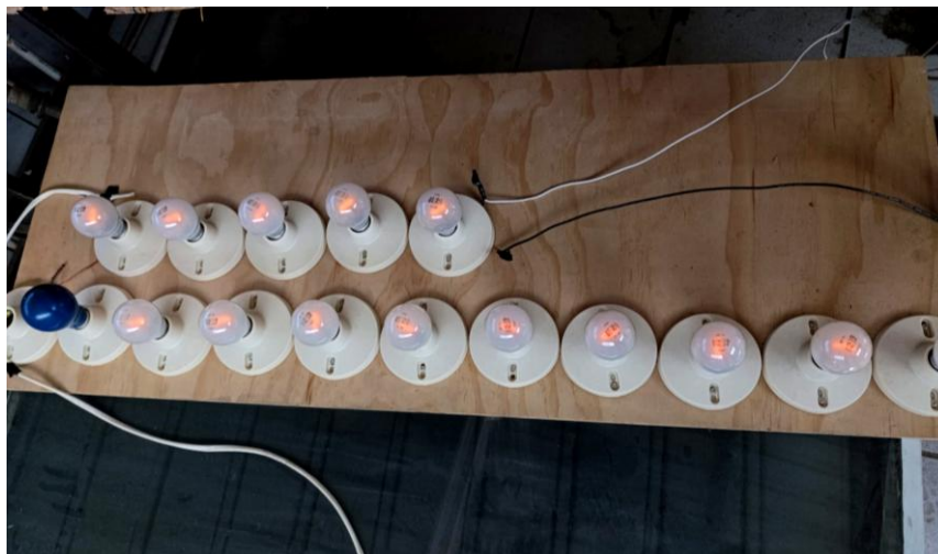
Ilustración 41 Carga de panel monofacial
