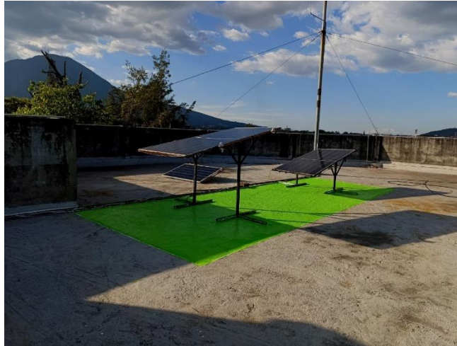
Ilustración 34 Configuración experimental sobre superficie pintada de verde.
