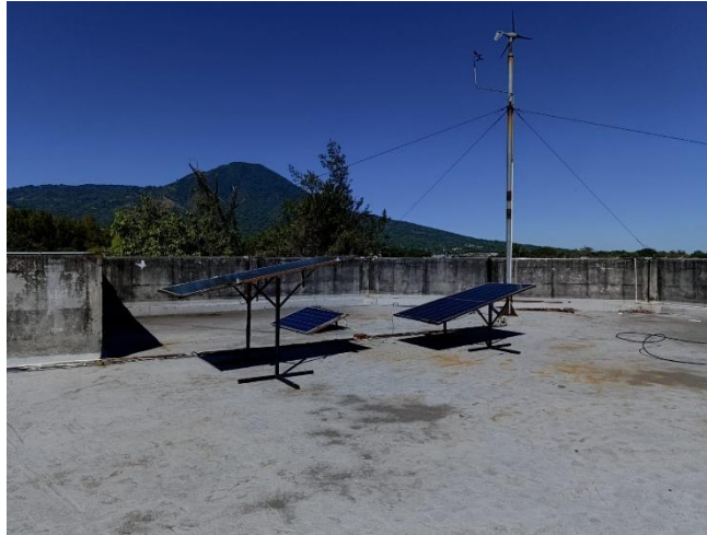
Ilustración 31 Configuración experimental sobre superficie de cemento sin pintar, condición de referencia inicial
