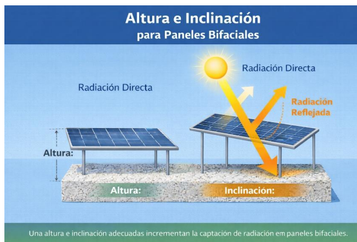
Ilustración 25 Altura e Inclinación para paneles bifaciales
