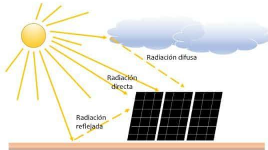
Ilustración 5 Tipos principales de radiación solar
