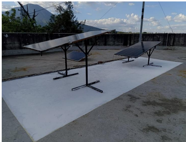
Ilustración 32 Configuración experimental sobre superficie pintada de blanco.
