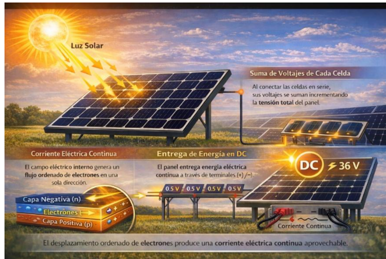
Ilustración 13 Magnitud de la corriente generada
