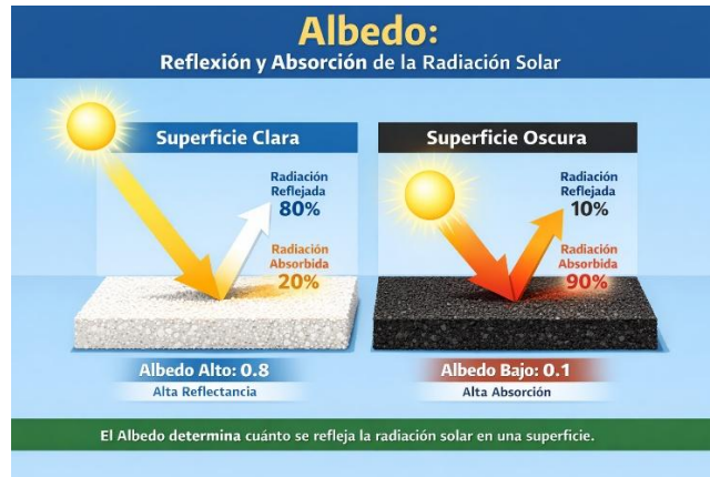
Ilustración 22 Albedo: Reflexión y Absorción de la radiación solar
