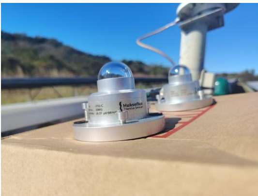
Ilustración 47 Calibración de piranómetros
