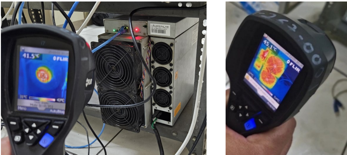
Figura 3-4. (a) Vista térmica del Antminer S19 Pro. (b) Imagen térmica de los ventiladores y disipadores de calor, con una temperatura de 45.1 ^{\circ}\text{C}
