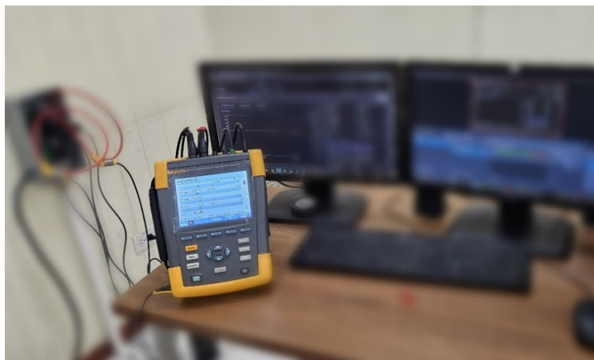
Figura 3-5. Vista del Fluke 435 en funcionamiento para las mediciones
