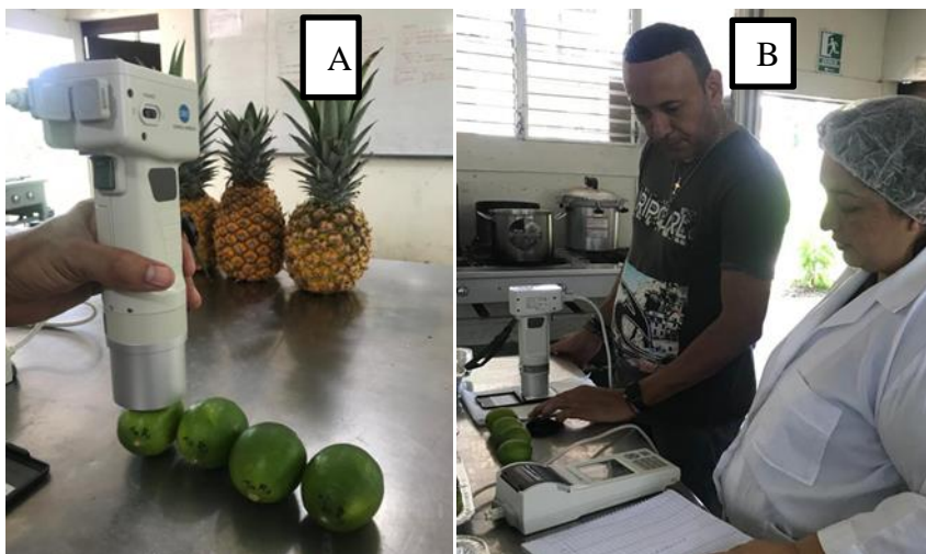
Figura 10: Colorímetro; (A) enfoque del lente, (B) lectura del aparato
