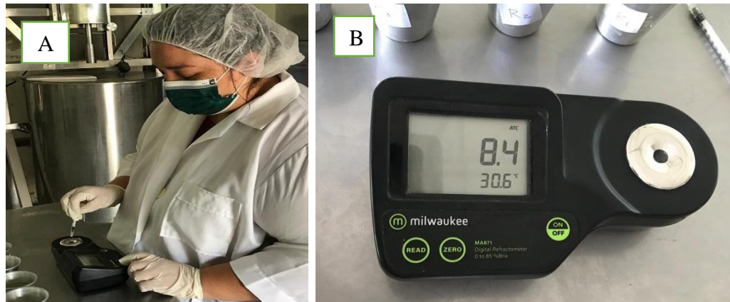
Figura 12: Medida de grados Brix, (A) colocando la muestra, (B) lectura de los resultados.
