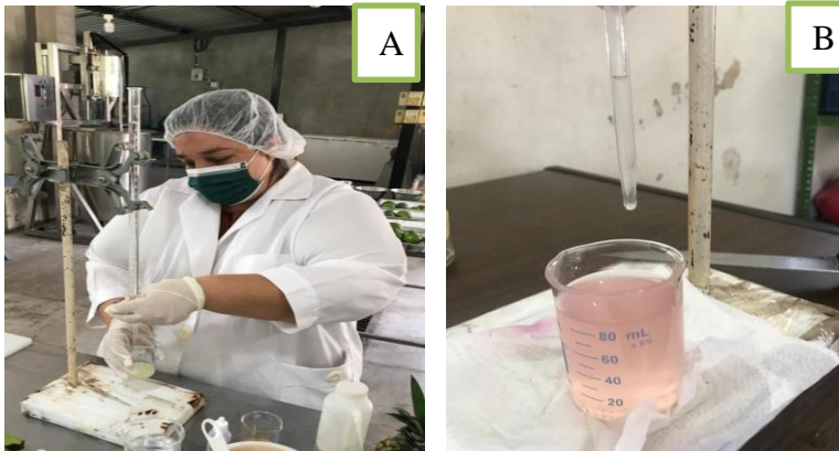
Figura 14: Titulación, (A) titulación de la muestra, (B) viraje de color rosa suave
