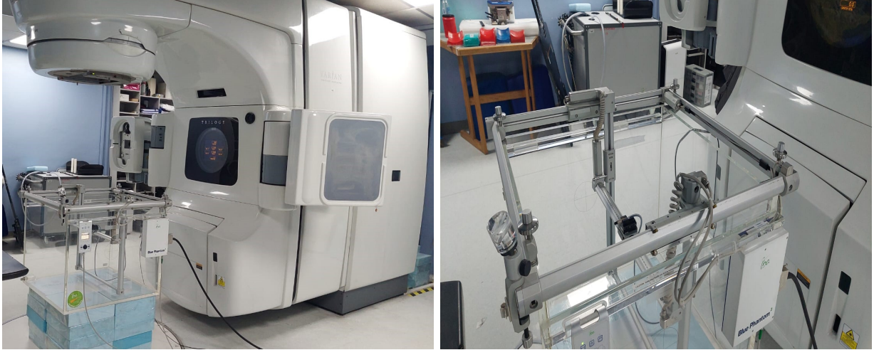
Figura 2.4: Configuración de montaje de la cámara de ionización CC13.
