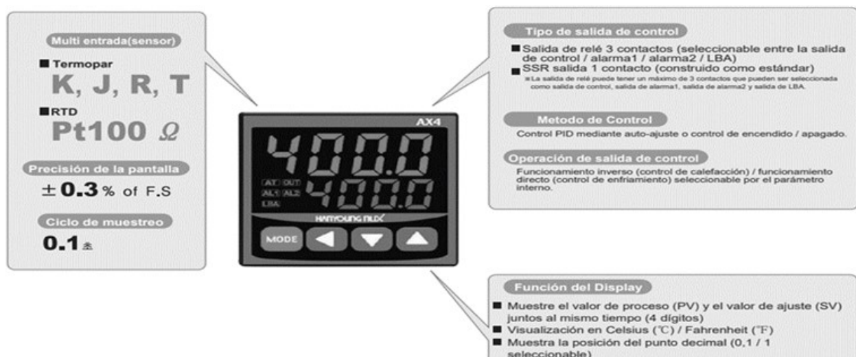
Fig. 2.13. Especificaciones generales controlador de temperatura AX2-1-A 48X96 mm [25 y 26].
