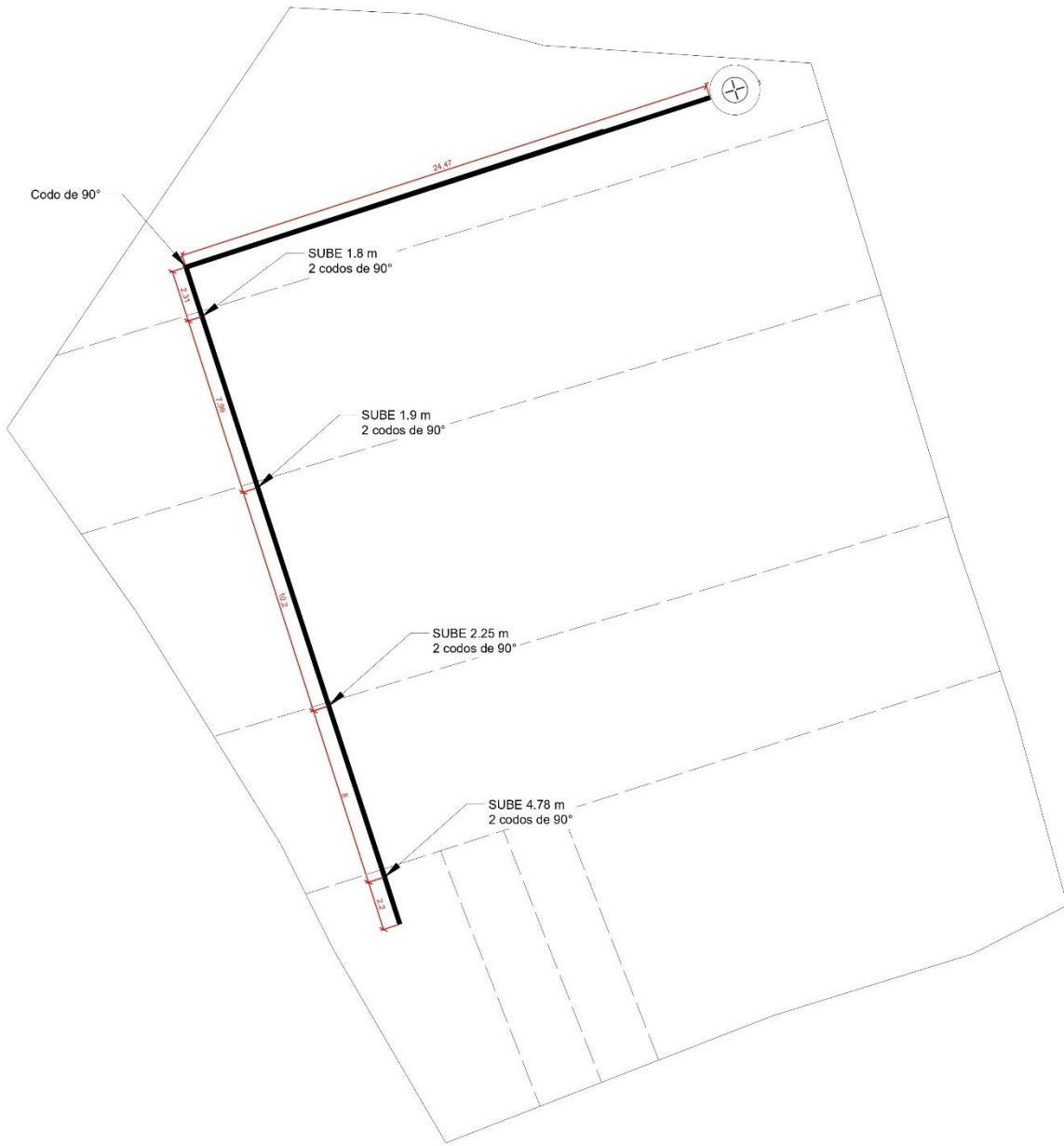
Figura 50. Tubería de Llenado de Tanque. Fuente: Propia.
