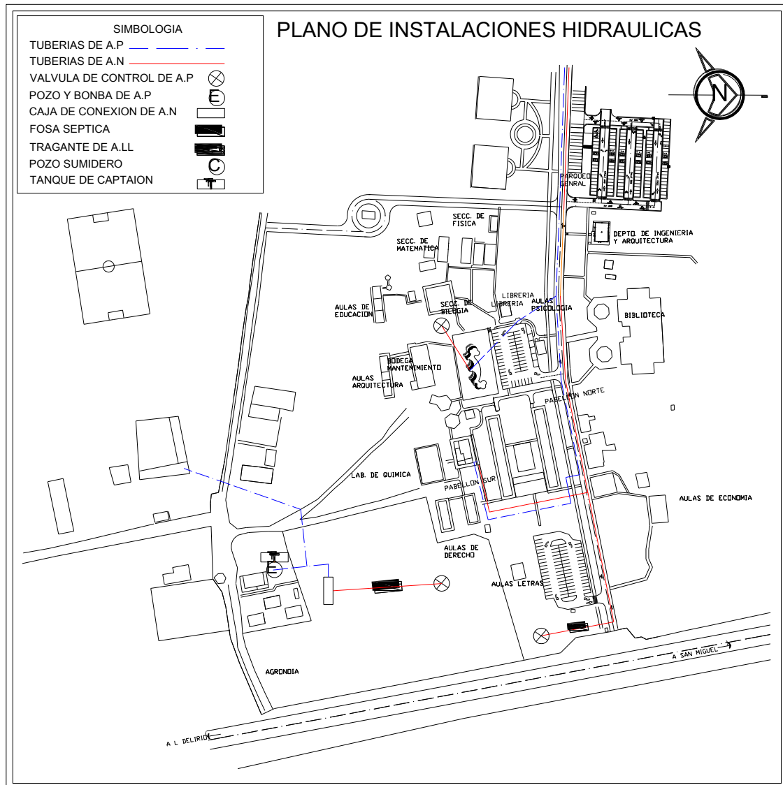
Imagen # 19 Planta de instalaciones hidráulicas
