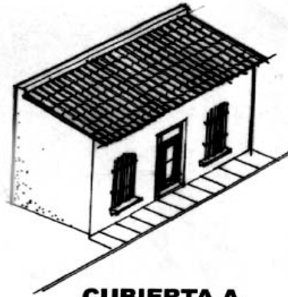
CUBIERTA A UNA AGUA
