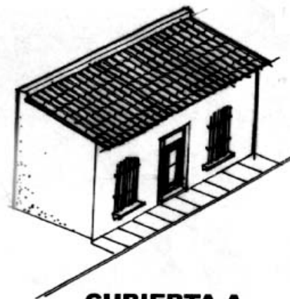
CUBIERTA A UNA AGUA
