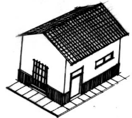
CUBIERTA A DOS AGUAS
