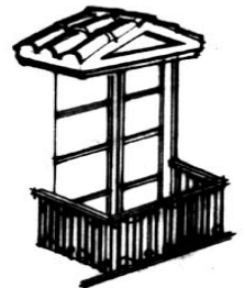
BALCON EN VOLADIZO
