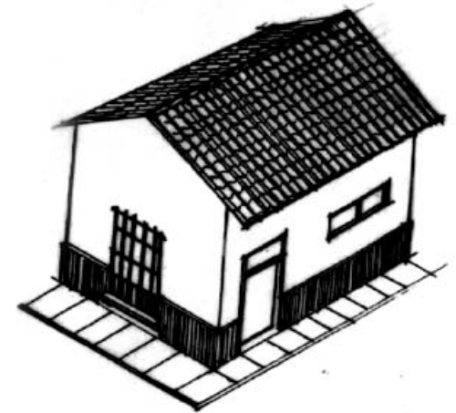
CUBIERTA A DOS AGUAS
