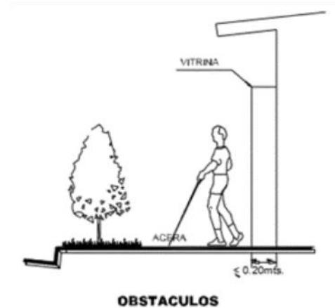
IMAGEN # 54: Detalle de obstáculos en aceras.
