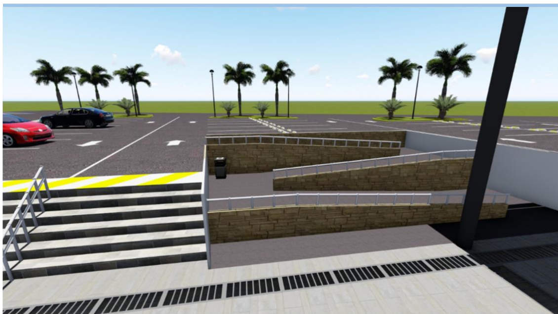
RAMPA PARA DISCAPACITADOS
